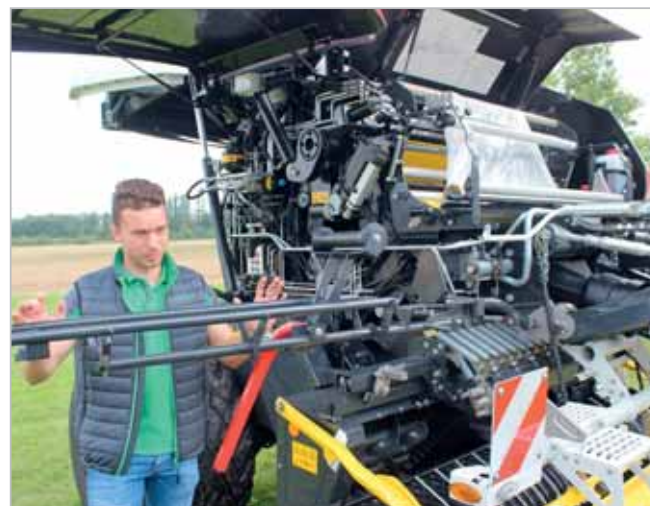
Výměna role bude s novými lisy Impress jednodušší a rychlejší díky novému otočnému nakládacímu stojanu
