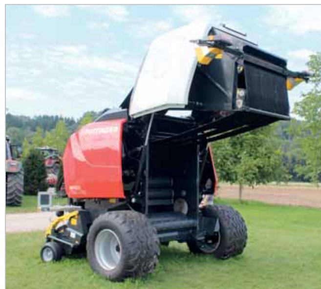
Kromě lisu Impress 3160 (na obrázku) se s variabilní lisovací komorou bude vyrábět také větší model Impress 3190 pro balíky o průměru až 190 cm
