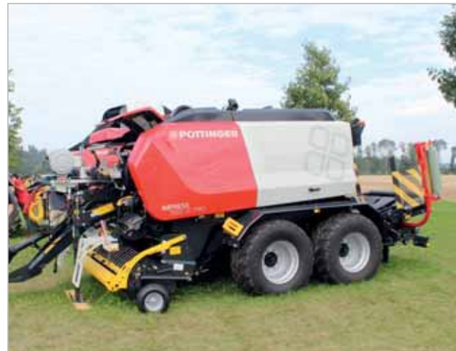
Pro všechny modely lisů Pro je nyní k dispozici nová jednotka s obvodovým fóliovým vázáním
