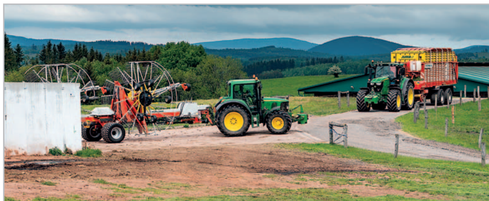
Přední dvojice rotorů je hnaná hydrostaticky. Důvodem je dosažení velkého rozsahu pracovního záběru i dodržení přepravní výšky do 4 m
