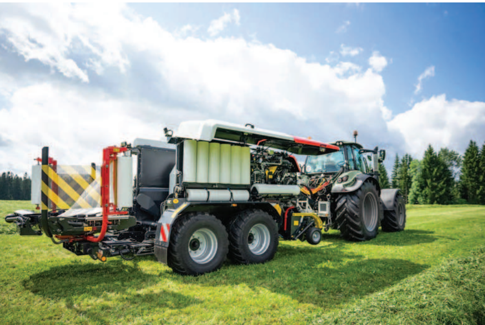
Obr.: Z praktického hlediska se majiteli líbí, že ovíjecí mechanismus umí plnohodnotně omotat balík i s jedním ramenem. Obsluha tak musí z traktoru vystoupit jen když dojde fólie na obou ramenech.
