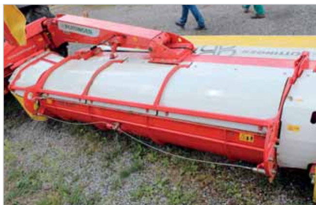
V uzavřené poloze krytu šnekového dopravníku Cross Flow je píce odebírána přímo od žacích disků a transportována na středový řádek
