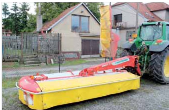
Vzadu nesený NovaCat 352 CF je vybaven šnekovým dopravníkem Cross Flow. Tento systém souběžné dopravy posečené hmoty na řádek se obejde bez zařízení pro úpravu píce
