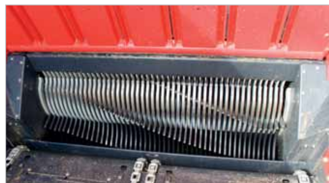
Hvězdicové válce jsou zúžené, zatímco stěrače jsou rozšířené, a efektivně se starají o to, že vkladací válec je udržován v čistotě. Hmoty z ložného prostoru nemůže zpětně tlačit na podávací rotor Foto Petr Beneš
