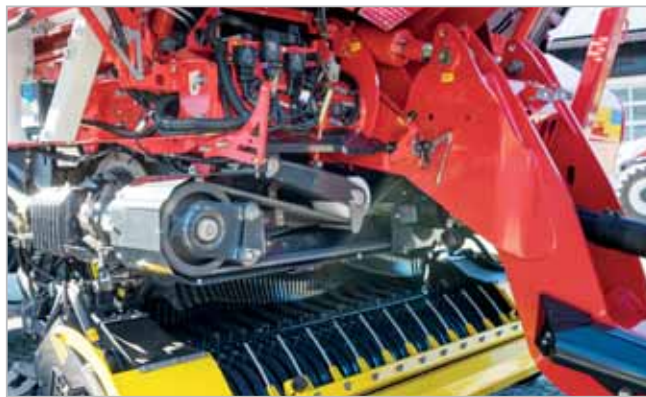
Zcela nový koncept pohonu u Jumba 7000 je založen na tom, že výkon je přenášen od vstupní převodovky na další převodovku pomocí sdruženého řemene. Výhodou je snížení opotřebení a intenzity vibrací Foto archiv
