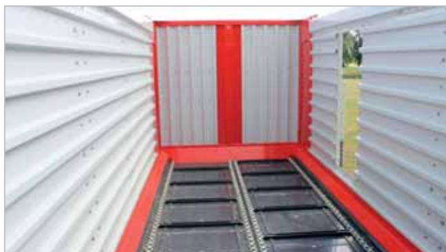
Nově se ložná plocha návěsu směrem odpředu dozadu rozšiřuje a konický tvar usnadňuje vyložení hmoty. Podlahu pokrývá lakovaný plech o tloušťce tří milimetrů Foto Petr Beneš
