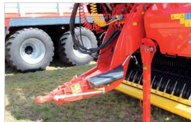
Tažná oj je stále výkyvná, na obrázku je vůz Jumbo s elektronicky ovládaným nuceným řízením nápravy Foto Petr Beneš
