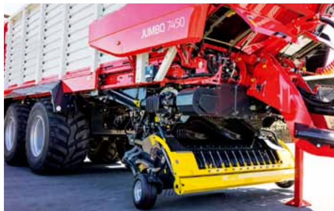
Nový koncept pohonu rotora. Pohon remeňa zaisťuje plynulý prenos energie za všetkých prevádzkových podmienok. Konštrukcia pohonu umožňuje plynulý chod a tlmiaci účinok v meniacich sa podmienkach nasadenia.
