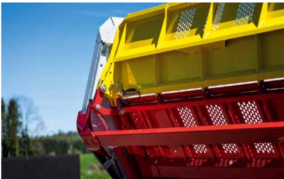
Nová čelná stena vozov dostala silomer. Pomáha stláčať hmotu a tým ušetriť až 4,3 m 3 objemu. Použití pritom môžete tri stratégie plnenia.
