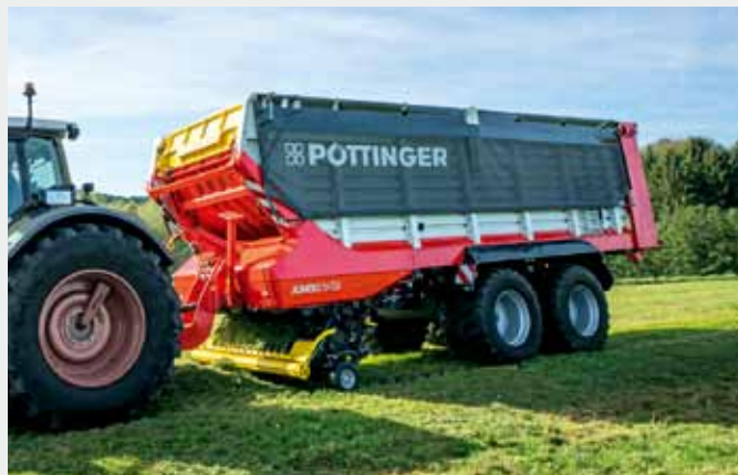
Jumbo 8000 má až 65 nožov, ktoré narežú hmotu na teoretických 25 mm a tým pomáha zvýšiť prepravnú kapacitu o 10 %.
