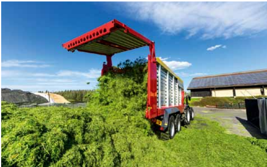
Vyprázdnenie do jednej minúty a novo tvarované rozdrúžovacie valce zlepšujú rozdelenie krmiva na jame.
