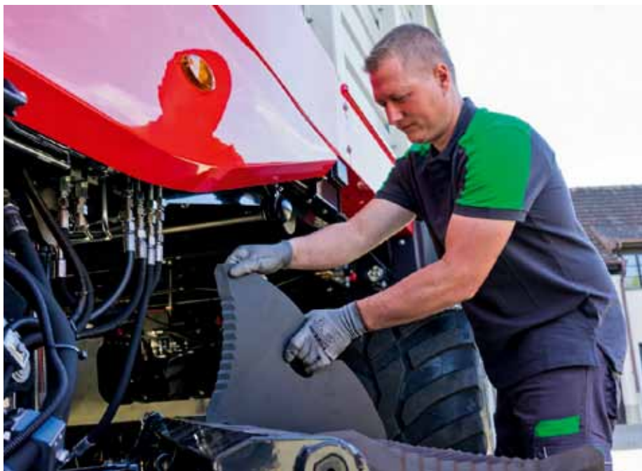
Pohodlná výmena nožov, ich obojstranné ostrie a automatické brúsenie sú stále benefitom zvyšujúcim výkonnosť.
