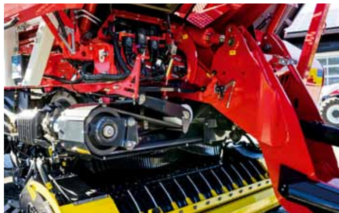
Nový koncept pohonu rotora. Pohon remeňa zaisťuje plynulý prenos energie za všetkých prevádzkových podmienok. Konštrukcia pohonu umožňuje plynulý chod a tlmiaci účinok v meniacich sa podmienkach nasadenia.
