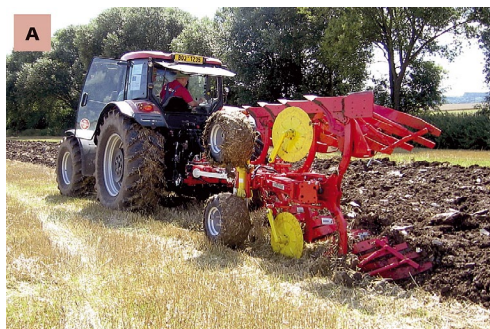
Měřené orební soupravy, traktor Zetor Forterra 150 HD s pluhem Pöttinger SERVO 45 M PLUS s páskovou odhrnovačkou (A) a pluh Pöttinger SERVO 45 M PLUS NOVA s plnou odhrnovačkou (B).
