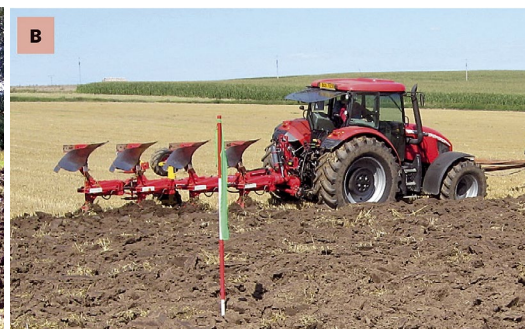
Měřené orební soupravy, traktor Zetor Forterra 150 HD s pluhem Pöttinger SERVO 45 M PLUS s páskovou odhrnovačkou (A) a pluh Pöttinger SERVO 45 M PLUS NOVA s plnou odhrnovačkou (B).
