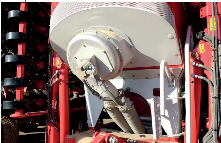
Ventilátor je na jiném místě a je výkonnější. Hned za ním se proud vzduchu rozděljuje do dvou vedení, každé z nich prochází pod jedním výsevním ústrojím
