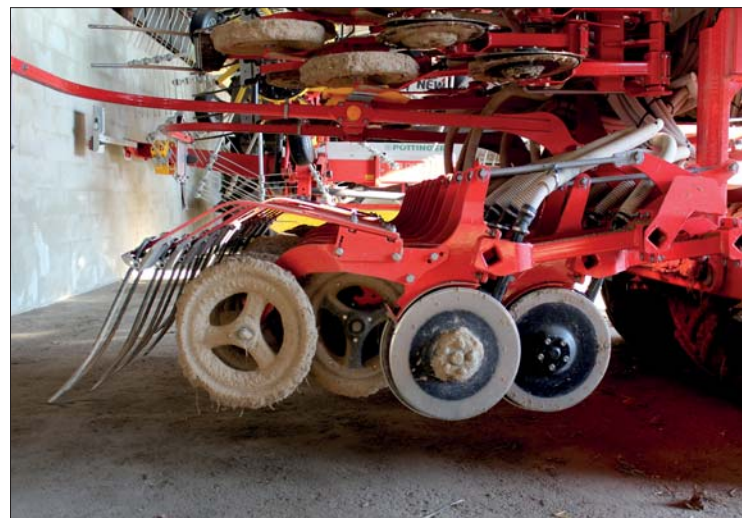
Dvoukotoučové secí botky s přítlačnými kolečky se na první pohled nezměnily. Ovšem jejich uspořádání ano – jsou uloženy také symetricky, podobně jako talíře pro přípravu půdy. Díky tomu nemá secí stroj žádný boční tah a nedriftuje
