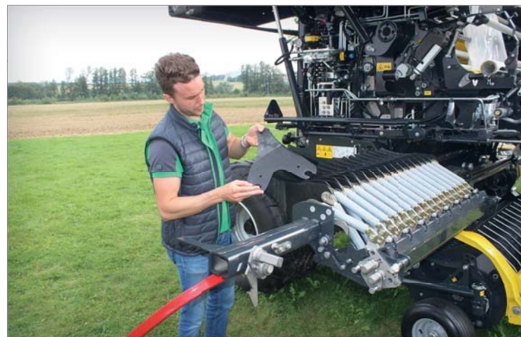
Impress ve variantě Pro je ve svém výsuvném nosníku vybaven 32 noži. Oboustranný nůž Twin Blade má dvě řezné hrany. Přepínání skupin nožů lze ovládat také bez vytahování nosníku nožů
