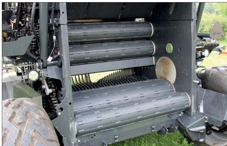
V komoře lisu Impress V jsou po stranách umístěné senzory, sloužící k měření vlhkosti sklizené píce
