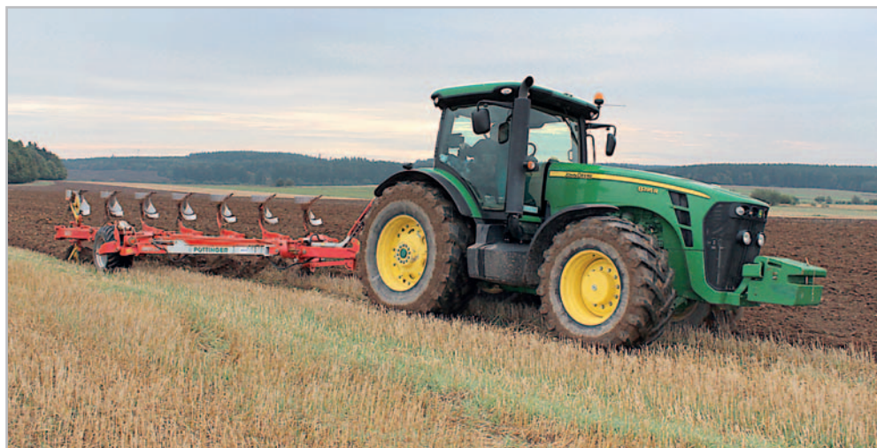
K orbě slouží polonesený pluh Pöttinger Servo 6.50 Nova. „Jsme s ním maximálně spokojeni, umí nám zajistit čistý stůl, a z důvodu polní hygieny má své místo vždy při setí ozimé pšenice po shodné předplodině,“ řekl Luboš Kroužek
