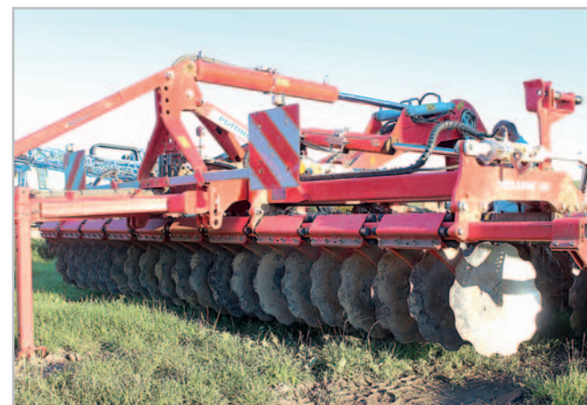
U talířového podmítače Pöttinger Terradisc 5001 T vede pevná slupice systému Twin Arm talíře spolehlivě v jejich záběru v půdě
