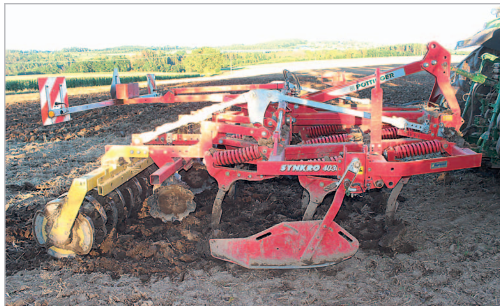
Radličkový kypřič Synkro 4030 K Nova slouží na Farmě Hejlov především ke kypření do větších hloubek. Třínosníkové uspořádání pracovních orgánů přispívá k homogenizaci rozložení slámy v půdním profilu
