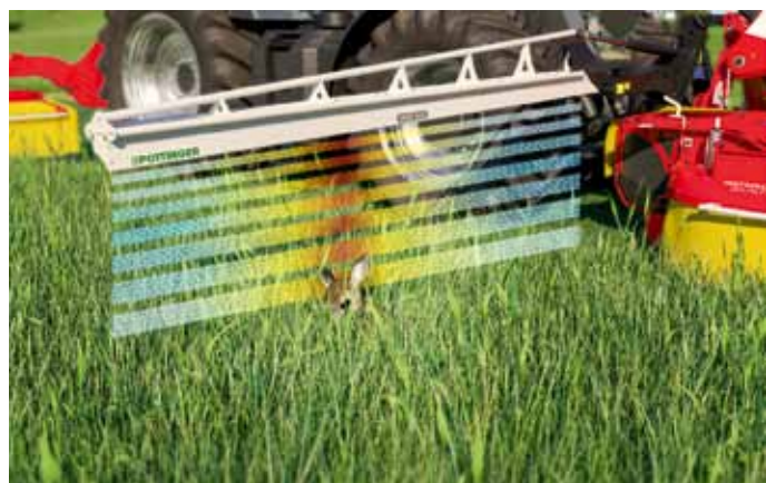
Srst' zvierat odráža svetlo inak ako porast, na čoho princípe systém pracuje.
