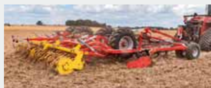
Terria 6040 má rovnaký počet radličiek osadených na viacerých nosníkoch. To spôsobuje väčšiu priechodnosť v prípade náročných podmienok.
