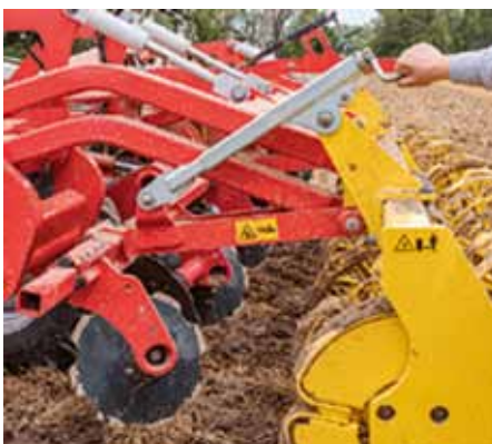
Urovnávacie taniere prepojené s paralelogramovo uchytенým valcom sa nastavujú samostatne.
