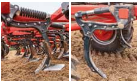
Istenie pružinami (vľavo) je sériové. Hydraulické istenie je ako opcia. Úplne nové sú 4 cm úzke radličky pre hlbšie kyprenie.
