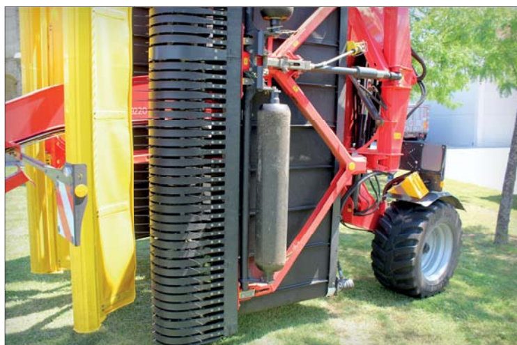
Pro ideální kopírování nerovností jsou opěrné válečky umístěny velmi blízko záběru prstů a s velkou kontaktní plochou po celé šířce sběrače
