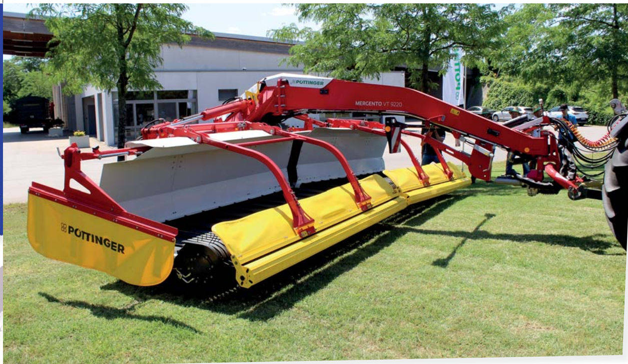
Nové Mergento VT 9220 umožňuje odkládat středový řádek, jeden stranový řádek vlevo nebo vpravo, dva jednotlivé řádky nebo dočasné naložení píce s krátkodobou dopravou
