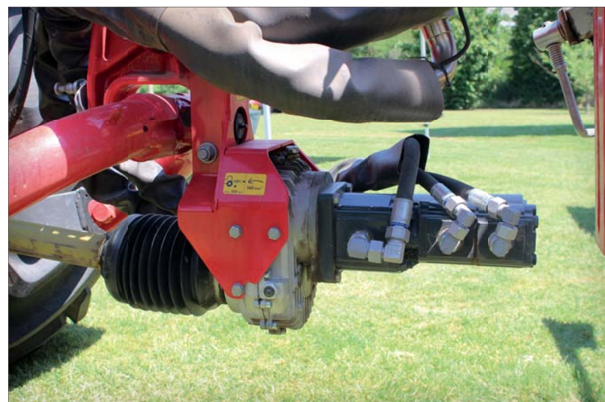
Celkem 150 litrů oleje uvádějí do pohybu tři hydraulická čerpadla – dvě jsou určena pro sběrače a jedno pro pásy. Čerpadla jsou uložena vpředu za závěsem a pohání je traktor vývodovým hřídelem
