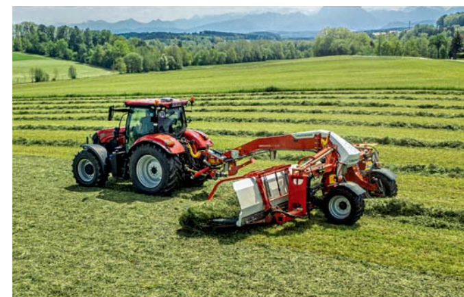
MERGENTO VT 9220 s pracovným záberom až 9,20 m pri ukladaní stredového riadku a 8,70 m pri ukladaní stranového riadku.
