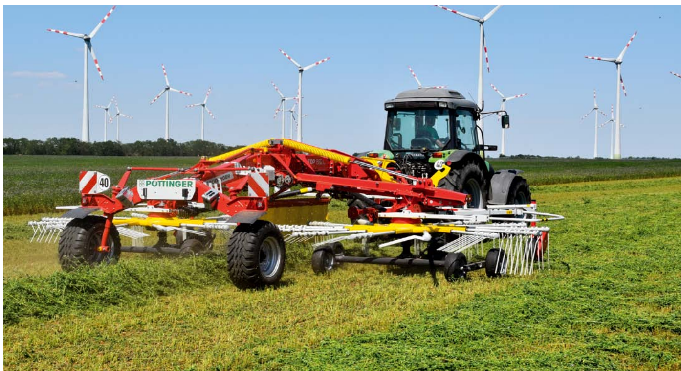
Päťkolesový podvozok spolu s unikátnym osvedčeným konceptom MULTITAST dosahuje výborné kopírovanie terénu.
