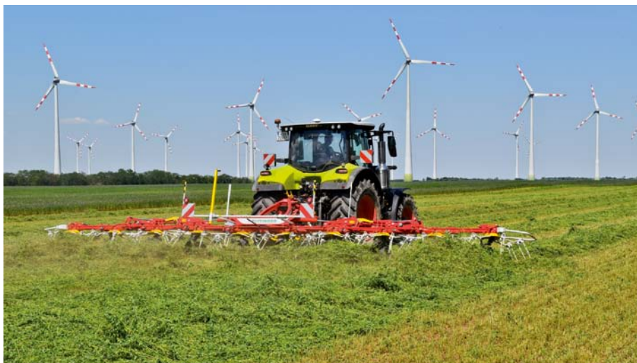
Nový nesený 10-rotorový obracač HIT V 11100 s priemerom rotorov 1,42 m a celkovým pracovným záberom 10,70 m.
