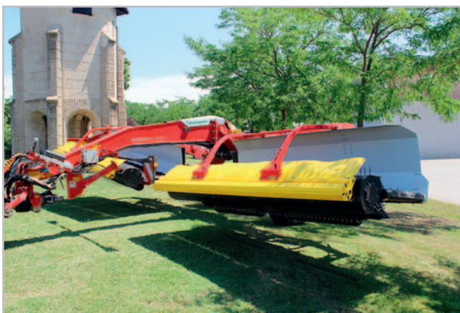
Nové Mergento VT 9220 umožňuje odkládat středový řádek, jeden stranový řádek vlevo nebo vpravo, dva jednotlivé řádky nebo dočasné naložení píče s krátkodobou dopravou
