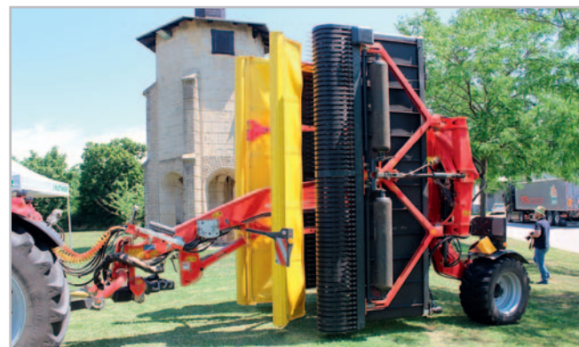
Složený v transportní poloze nemá řádkovač Mergento VT 9220 výšku větší než čtyři metry. Je-li zapotřebí při výjezdu z pole překonat větší nerovnosti, pak lze složený stroj hydraulicky přizvednout
