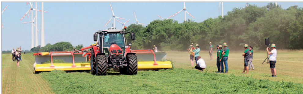
Tím, že píče není dopravována po zemi, ale po dopravníku, se minimalizují ztráty odrolem, zejména u plodin s velkým podílem lístků. Sklizené krmivo tak má vyšší energetickou hodnotu a méně popelovin
