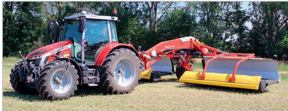
Agregovaný traktor by měl mít výkon 100 až 120 k. Na tiskových dnech byl pásový řádkovač Mergento VT 9220 agregován s traktorem Massey Ferguson 5S.145 o výkonu 145 k. Traktor měl instalován systém centrální regulace tlaku vzduchu TerraCare
