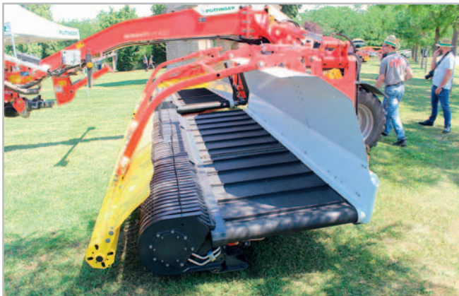
Příčný dopravníkový pás je umístěn o 120 mm níže než vodičí pruhy sběrače. Výsledkem je, že během nasazení padá sklizený materiál snadno na pás
