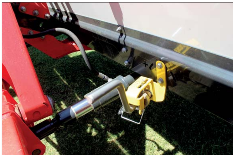
S pomocí této kliky a přehledné stupnice je možné změnit nastavení výšky prstů nad terénem
