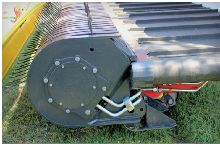
Hydraulický pohon je integrován přímo ve sběrači. Sklizená plodina je šetrně sbírána ze země aktivně řízenými prsty a urychlována směrem k příčnému dopravnímu pásu
