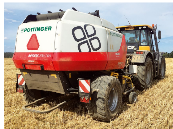
Druhou sezonu využívají na rodinné farmě v Raspenavě lis na kulaté balíky s variabilní komorou IMPRESS 155 V PRO s šířkou sběrače 2,30 metru.
