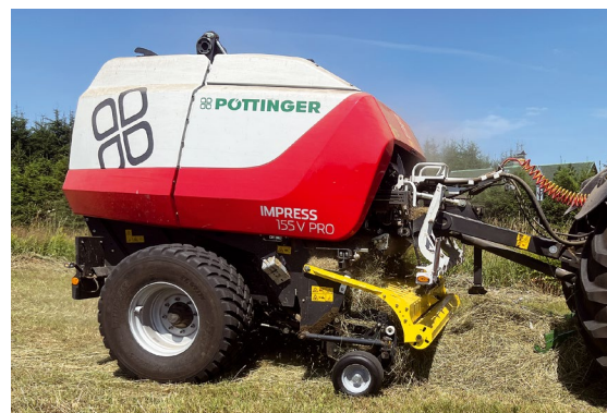
Lis s variabilní komorou IMPRESS 155 V PRO. Na rovině dokáže slisovat až 65 balíků za hodinu.
