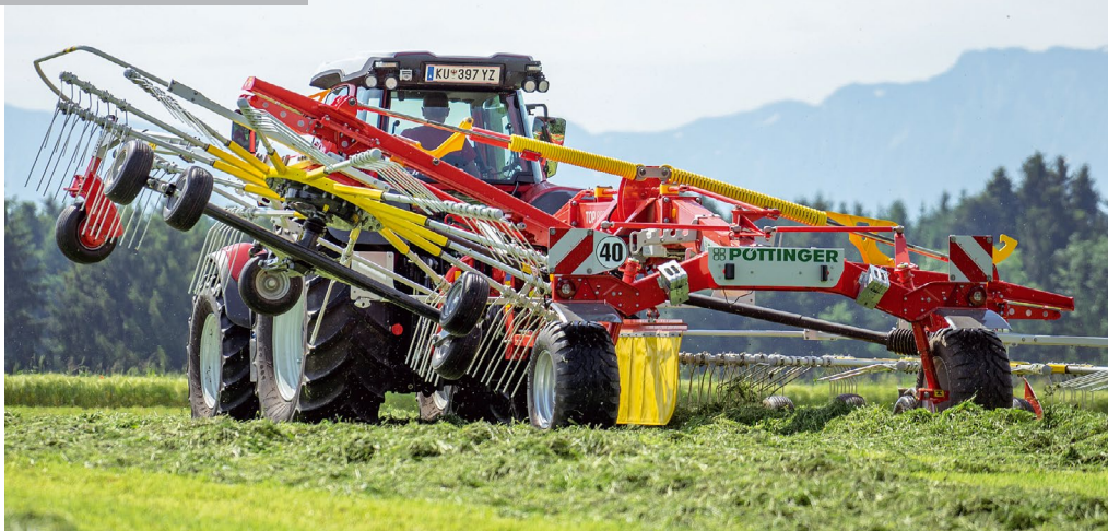
Zbytkové plochy nebo krajové řádky jsou zpracovávány volitelně dostupným individuálním zdvihem s elektrickou předvolbou.
