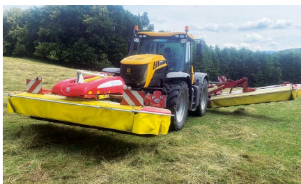
Žací kombinace NOVACAT A10 s čelním žacím strojem NOVACAT 301 ALPHA MOTION s pracovním záběrem deset metrů.
