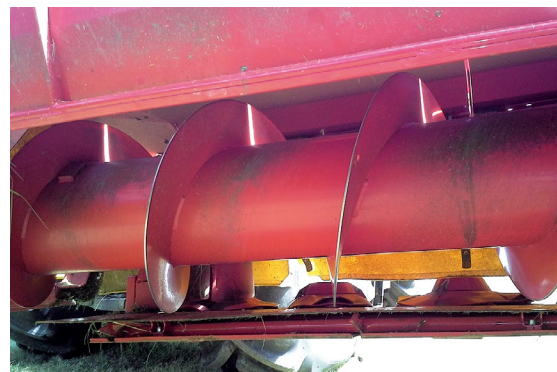
Detail šnekového dopravníku u žacího stroje NOVACAT 302 CF, který umožňuje sklizeň ve dvou krocích.
