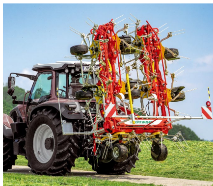
Desetitorový HIT V 11100 je špičkový obrabeč s maximální manévrovatelností při práci i dopravě.
