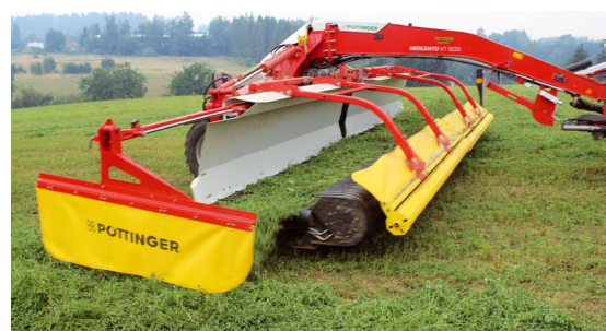
Nový pásový řádkovač MERGENTO VT 9220 s pracovním záběrem až 9,20 metru umí ukládat středový i stranový řádek. Určený je pro sklizeň vojtěšky, jetele, trvalých travních porostů a také slámy.
