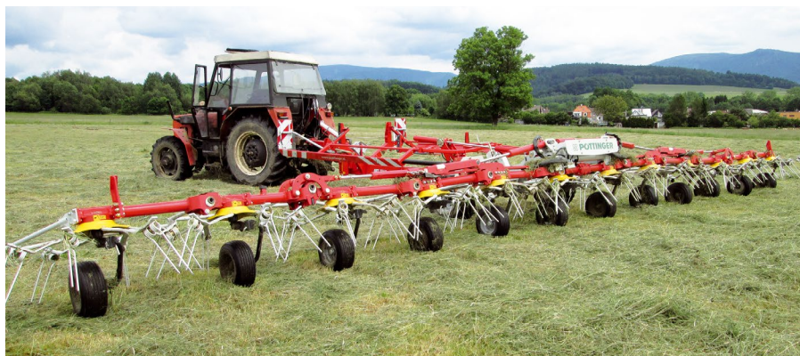
Perfektní kopírování nerovností, vysoká výkonnost při šetrné manipulaci s píčí a její minimální znečištění, to bezzbytku splňuje tažený obrať HIT 12.14 T s dvanácti rotory a pracovním záběrem 12,70 metru.
