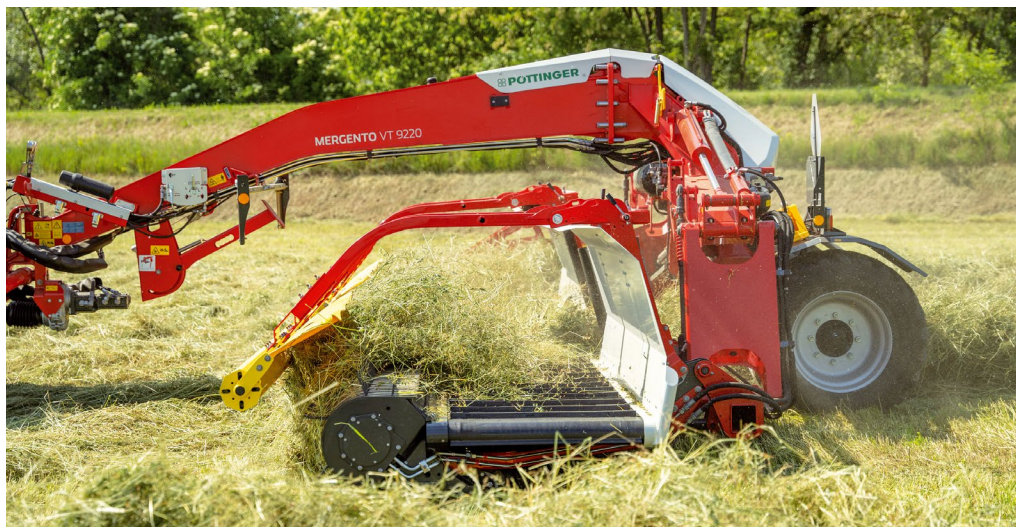
MERGENTO šetrně sbírá píci řízeným sběračem. Na zemi zůstávají nečistoty a kameny. Píce je šetrně bez dalšího kontaktu se zemí dopravována příčnými dopravníkovými pásy a ukládána do pravidelného řádku. Pásový řádkovač PÖTTINGER minimalizují ztráty odrolem, zejména u suchých nebo listnatých plodin, protože píce není dopravovaná po zemi. Výsledkem je energetické krmivo s nižším podílem popelovin.
