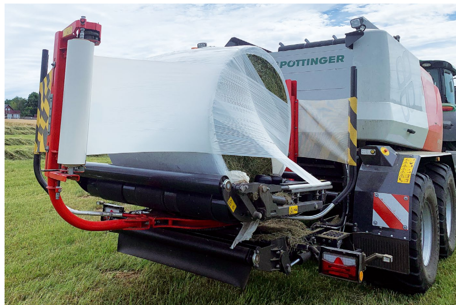
Lis na kulaté balíky s variabilní komorou a integrovanou ovíječkou IMPRESS 3160 VC PRO je vybavený obvodovým fóliovým vázáním, které více stlačí vnější vrstvu hmoty, což zajišťuje tvarovou stabilitu balíku.
