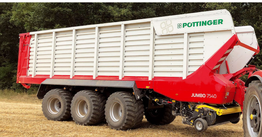
JUMBO 7540 je predstaviteľom novej generácie senážnych vozov. Hlavné komponenty týchto vozov boli kompletne prepracované a dimenzované pre agregáciu s traktorom o výkone až 500 k.
