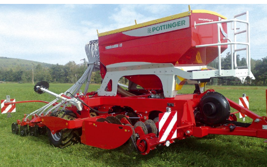
S univerzálním secím strojem TERRASEM R3 se záběrem tři metry sejí na farmě všechny plodiny na orné půdě. Ročně zaseje kolem 140 až 150 ha a bez problémů pracuje i s traktorem o výkonu 120 k.
