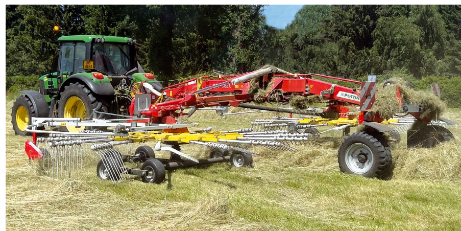
Dvourotorový středový shrnovač TOP 962 C se záběrem 9,60 metru perfektně připraví řádek pro lis.
