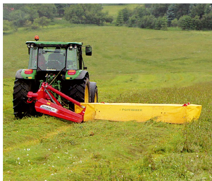
Nesený diskový žací stroj NOVADISC 350 s pracovním záběrem 3,46 metru při sklizni pícnin.
