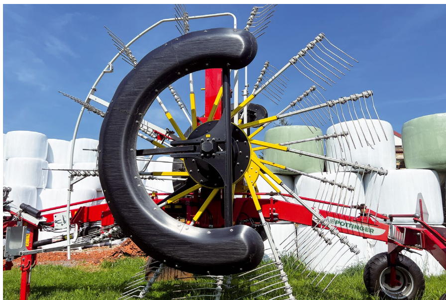
Inovativním řešením dvourotorového středového shrnovače TOP 842 C jsou objemné plazy ve tvaru srpů, namísto podvozku s pneumatikami. Plazy dokážou kopírovat i mokré a velmi nerovné pozemky po celé pracovní ploše dráhy prstů. Pracovní záběr shrnovače je 8,40 metru.
