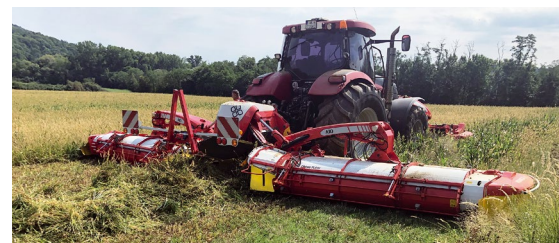
Nová žacia kombinácia NOVACAT A10 CF so systémom CROSS FLOW pre priamu tvorbu riadku.
