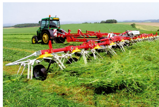
Širokozáběrový tažený obračec HIT 1214 T s pracovním záběrem 12,70 metru.
