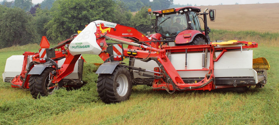
Pokud je méně hmoty, MERGENTO VT 9220 dokáže vytvořit dvojitý řádek ze záběru až osmnáct metrů.
