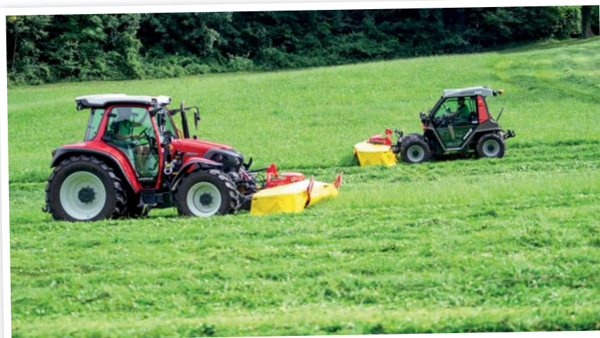
Nové žací stroje Novacat F Alpin mohou být agregovány jak s traktory, tak i se svahovými nosiči nářadí
