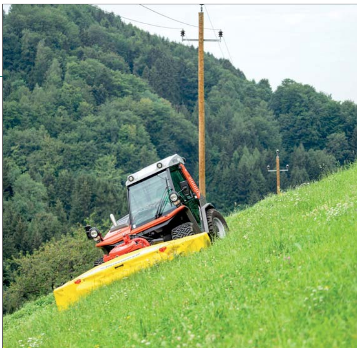
Na nejsvažitějších loukách se žací stroje Novacat F Alpin výborně osvědčují. Může za to jejich nízká celková hmotnost a díky krátké konstrukci v blízkosti traktoru usazené těžiště
