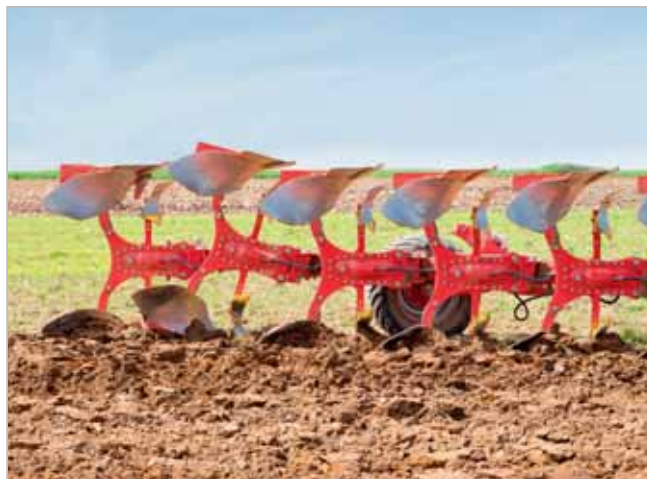
Požadovaný tlak v systému jištění je možné rychle nastavovat jednočinným vnějším hydraulickým okruhem, a to až do vypínací síly 220 kN
