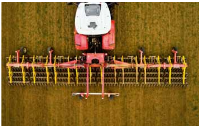
Centrálne usporiadanie hlavného rámu zaisťuje optimálne rozloženie hmotnosti a rovnomerný prítlak na hroty po celej pracovnej šírke.
