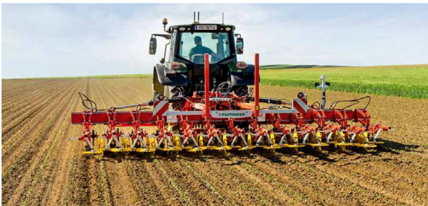
Plečka sa navádza manuálne okruhom hydrauliky traktora, alebo automaticky pomocou jednej alebo dvoch 2D kamier.
