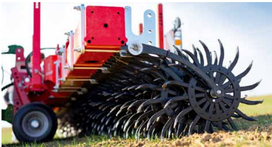
Výrobca udáva pre rotačné plečky Rotocare pracovnú rýchlosť 10 až 30 km za hodinu, hĺbku do 4 cm. Sú nezávislé na riadkoch.
