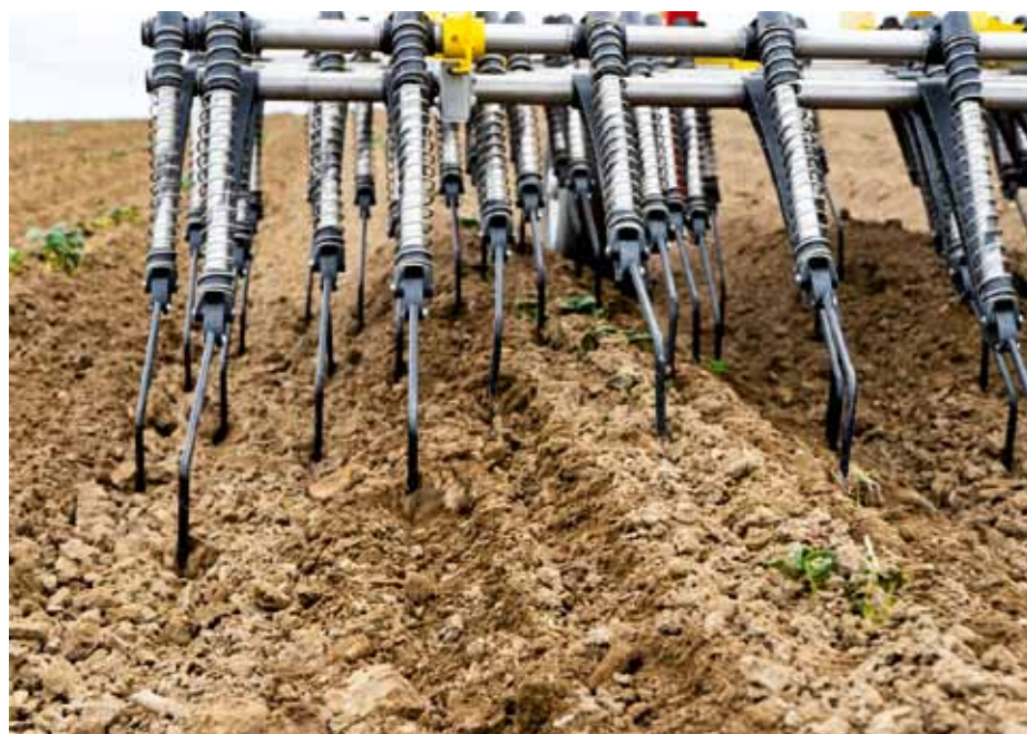
Hroty majú patentované uchytenie. Ich rozstup je 30 mm. Sú tak flexibilné, že dokážu pracovať aj na hrobčekoch zemiakov.
