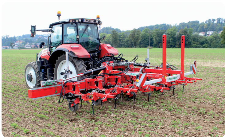
Flexcare V 6200 je prostřední model řady o záběru 6,2 m. Díky kompaktní konstrukci se těžiště plečky nachází v blízkosti traktoru
