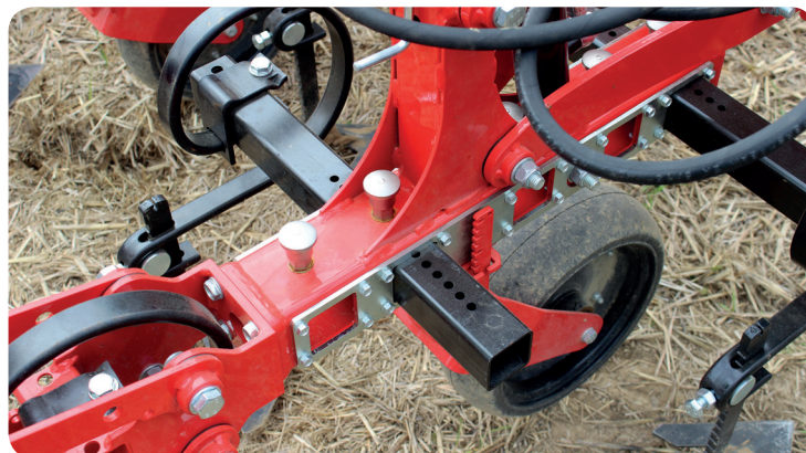
Radličkové plečky Pöttinger Flexcare V mají rozsáhlé možnosti precizního nastavování
