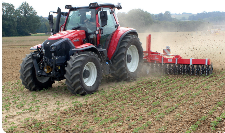
Při pracovní rychlosti 15 - 30 km/hod jsou požadované pracovní kroky s plečkou Rotocare V prováděny rychle, levně a s vysokou výkonností. Agresivita působení stroje na půdu a plevele je přímo úměrná rychlosti jízdy
