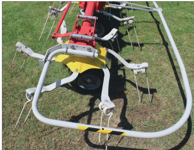
Díky malému průměru rotorů a šesti zakřiveným ramenům prstů se docílí vysoké kvality rozhozu pro všechny druhy píce
