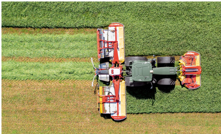
Pro slučování řádků může být NOVACAT V 10000 volitelně vybavený osvědčenými příčnými shazovacími pásy COLLECTOR nebo příčnými šnekovými dopravníky CROSS FLOW.
