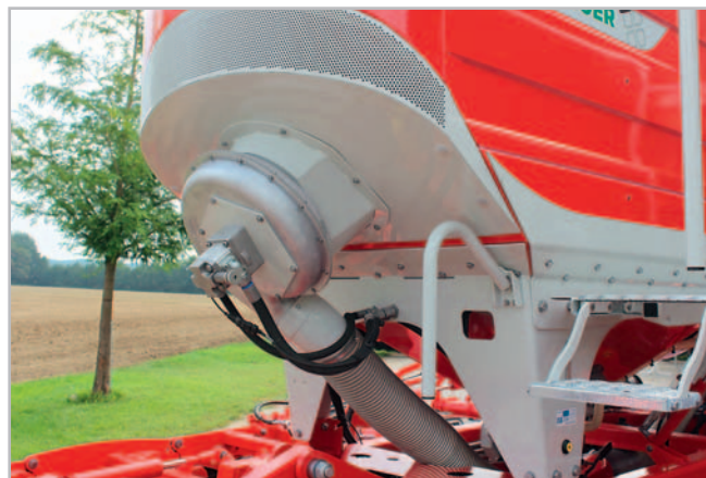
Ventilátor je na jiném místě a je výkonnější. Je-li zásobník řešen jako dvoukomorový, hned za ventilátorem se proud vzduchu rozděluje do dvou vedení, každé z nich prochází pod jedním výsevním ústrojím
