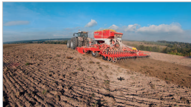
Možnost seti dvou plodin najednou či jedné s přihnojením zvyšují produktivitu práce a šetří čas i náklady. Zároveň je možné seti do podmítky, po kypřiči, po orbě i do strniště
