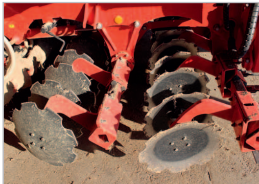
Talíře pro přípravu půdy jsou nově v symetrickém uspořádání. „Talíře jdou do půdy dobře, udržují nastavenou hloubku zpracování půdy a dělají velmi pěknou práci. Zároveň secí stroj pěkně drží stopu a nikam neuždí ani na svahu,“ řekl Ladislav Chmelík
