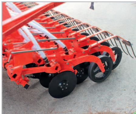
Dvoukotoučové secí botky s přítlačnými kolečky jsou uloženy také symetricky, podobně jako talíře pro přípravu půdy. Díky tomu nemá secí stroj žádný boční tah a nedriftinguje
