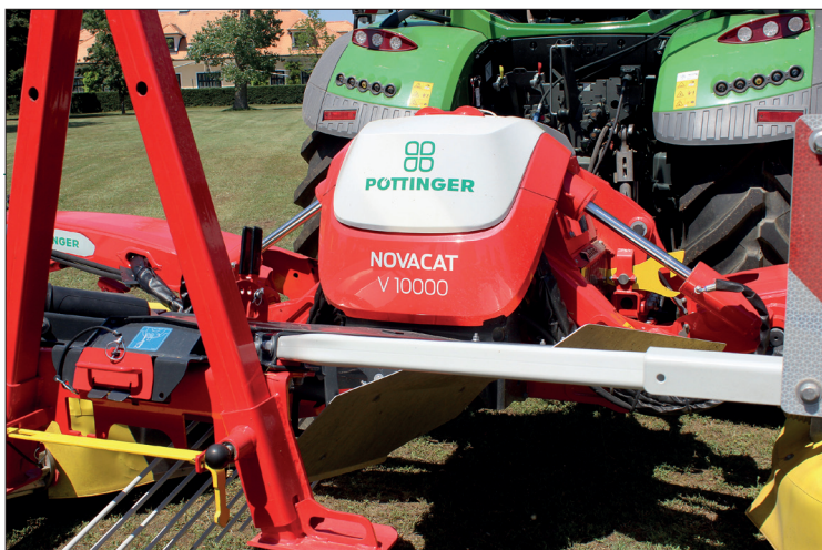
Stejně, jako i ostatní žací kombinace firmy Pöttinger, je i NovaCat V 10000 vybalancován tak, že při zdvihu jedné jednotky zůstává ta druhá ve své pracovní poloze zcela beze změny
