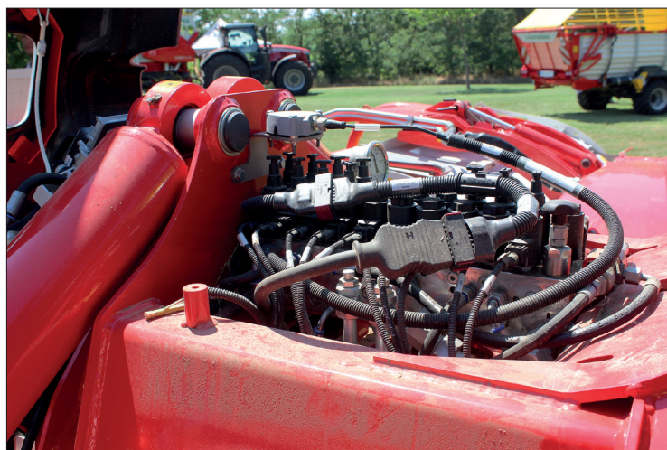
Po odklopení krytu závěsu kombinace je patrný manometr systému hydraulického odlehčení a kabely elektrického a hydraulického vedení. V závěsu kombinace může být senzor, který informuje řidičskou jednotku kombinace o tom, že se souprava právě pohybuje na svahu
