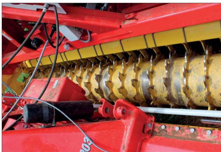
Zubový opěrný válec zanechává optimálně zpevněné osivové lože s jemnou zeminou v úrovni setí. Proti zalepování je vybaven ztuštěnými škrabkami (volitelná výbava)
