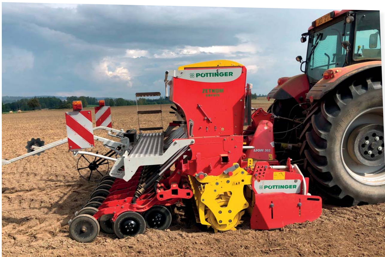
Nastavbový secí stroj Vitasem ADD je uložen přímo na válci, který přenáší hmotnost secího stroje na půdu. Tím jsou také účinně eliminovány vibrace od rotačních bran a umožněno vyrovnávání nerovností nezávisle na rotačních branách
