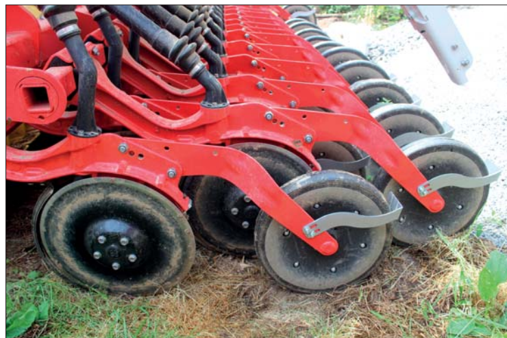
Dvoukotočové secí botky zvládají výsev v prostředí s posklizňovými zbytky na povrchu půdy hladce. Přítlačná kolečka odvádějí svou práci v písčítých i kamenitých půdách znamenitě. Aby nedocházelo k jejich zalepování, byla doplněna o škrabky
