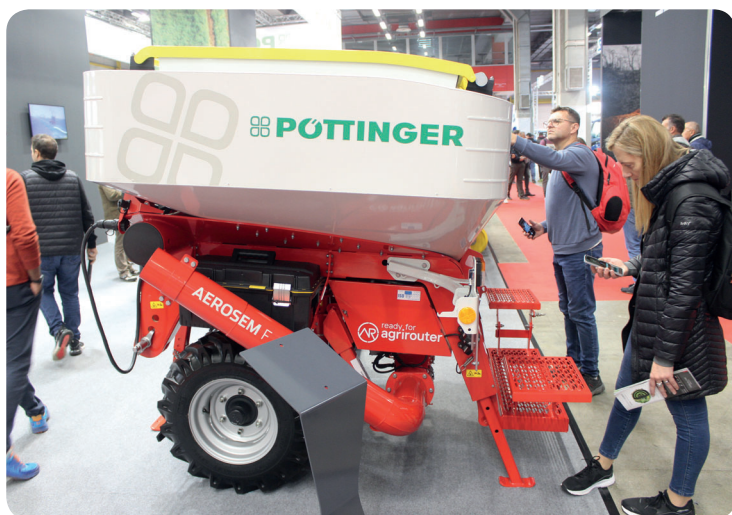
Čelně nesený zásobník Pöttinger Amico F může být vyroben s objemem 1700 anebo 2400 litrů, s rozdělením na dvě komory v poměru 60 : 40. Standardně je ovládán pomocí ISOBUS
