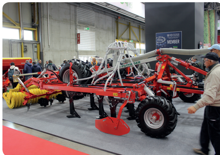
Radličkový kypřič Pöttinger Terria je doplněn o rozdělovací hlavu, hadicové rozvody a aplikační koncovky. Ty mohou být nastaveny do různých poloh. Výměnné radličky dovolují využití kypřiče jak při mělké podmítce, tak i při kypření půdy do větších hloubek
