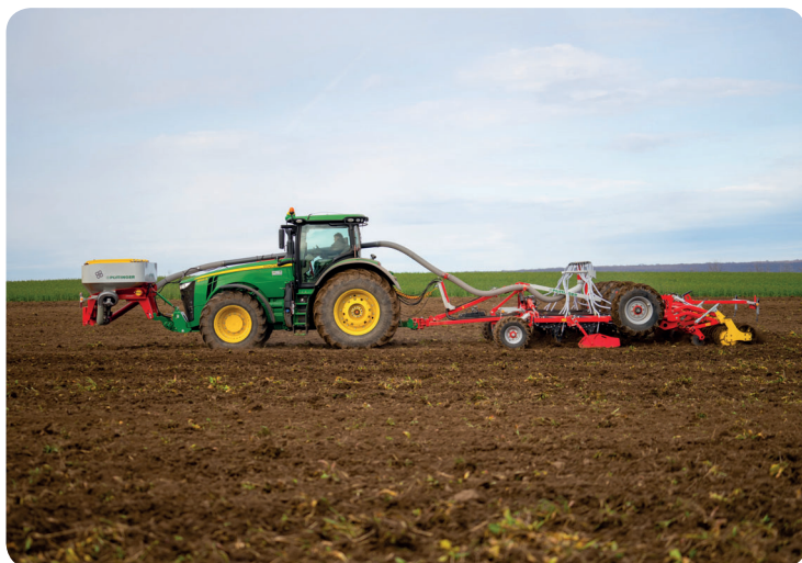
Cílem kombinace radličkového kypřiče Terria firmy Pöttinger s čelně neseným zásobníkem Amico F je provést nakypření půdy a současnou aplikaci hnojiva do půdního profilu, kde mohou být živiny vegetujícími rostlinami kulturní plodiny využity přímo a beze ztrát
