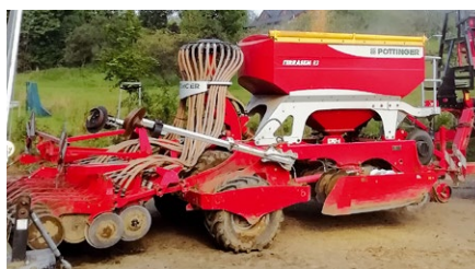
Univerzální sečí stroj TERRASEM R3 je z roku 2012. Přípravu půdy u něj přebírá dvouřadý diskový podmiřtač. Dvoudiskové sečí botky vedené širokými utužovacími válečky zaručují rovnoměrnou hloubku výsevu.
