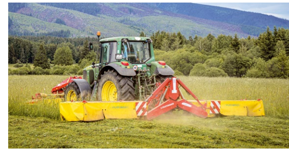
Žacia kombinácia NOVADISC 730 s čelným žacím strojom NOVACAT 306 ALPHA MOTION a pracovným záberom 7,30 metra.
