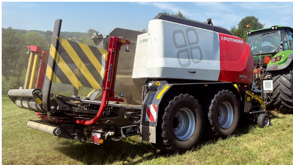
Vlajkovou lodí ve strojním parku Mariána Kalety je lis s variabilní komorou IMPRESS 3160 VC PRO. Tato kombinace lisu a ověječky se dokáže přizpůsobit každé situaci při sklizni. Optimálně zhutní jakýkoliv materiál.
