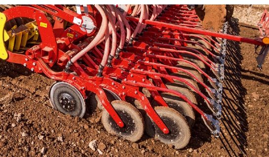
Dvoudiskové botky DUAL DISC s maximálním přitlakem 60 kg jsou vhodné pro setí v náročných podmínkách. Hloubku uložení osiva garantují opěrná kolečka za každou botkou. Kromě dodržení hloubky zajišťují kolečka také cílené opětovné utužení řádku osiva.
