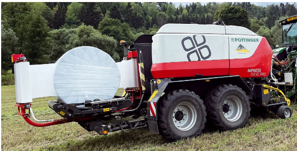
Lis s variabilní komorou a integrovanou ovíječkou IMPRESS 155 VC PRO je vhodný pro různé podmínky nasazení. Lisování a ovíjení v jedné operaci umožňuje kvalitní sklizeň při jednom přejezdu i na svazích.
