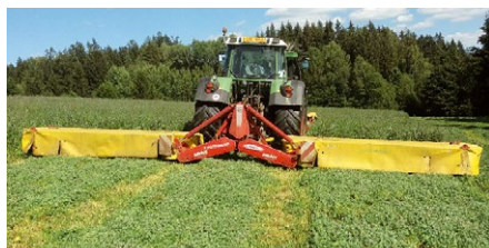
Disková žací kombinace NOVADISC 900 s čelním žacím strojem NOVACAT 301 F ALPHA MOTION. Pracovní záběr má 9 metrů.
