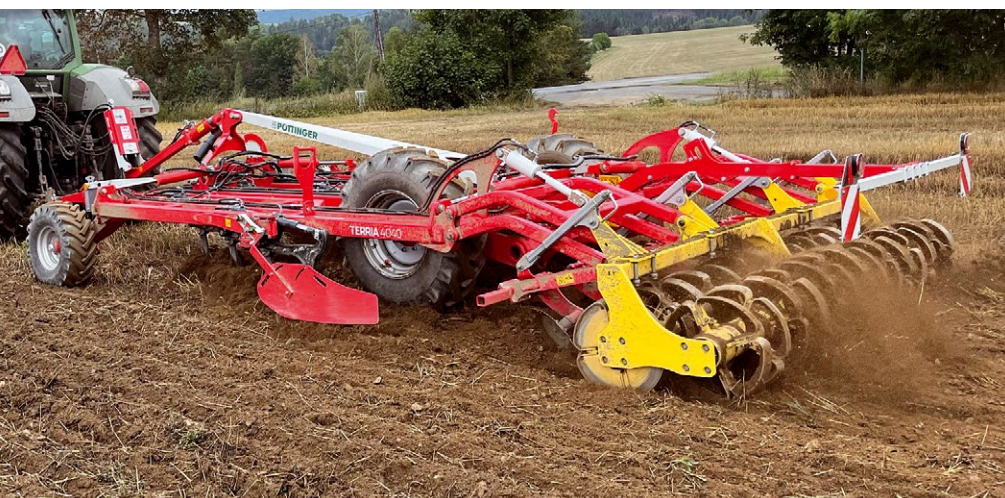
Tažený čtyřřadý radličkový kypřič/podmítač TERRIA 4040 se záběrem čtyři metry pracuje ve společnosti REGENT PLUS od minulého roku. Pěstitelé si tento stroj vybrali kvůli široké variabilitě obdělávání půdy, od měličho zpracování strniště až po hlubší kypření. Vybavený je nonstop jistěním radliček proti přetížení.
