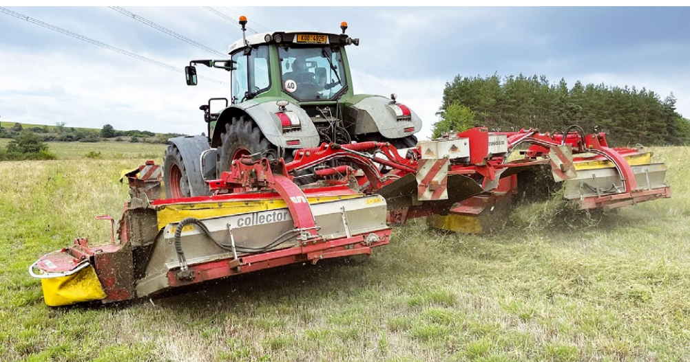
Disková žací kombinace NOVACAT X8 ED COLLECTOR s čelní žací lištou NOVACAT 301 F ED ALPHA MOTION má za sebou šest sezon. Každoročně poseče kolem 1 500 ha ve dvou sečích v agregaci s traktorem 360 k.
