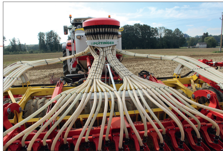
K secím botkám vedou osivo semenovody od velké centrální rozdělovací hlavy, shodné jako u secích strojů řady Terrasem či Aerosem. Možný je také různý rytmus a šířka kolekových mezířádků
