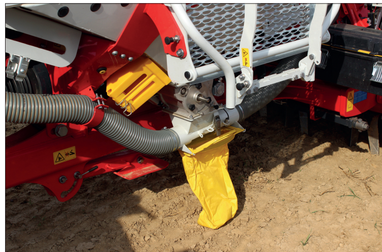
Nízko uložený velký zásobník osiva je snadno přístupný pro doplňování, ale i výsevní zkoušku lze provádět pohodlně
