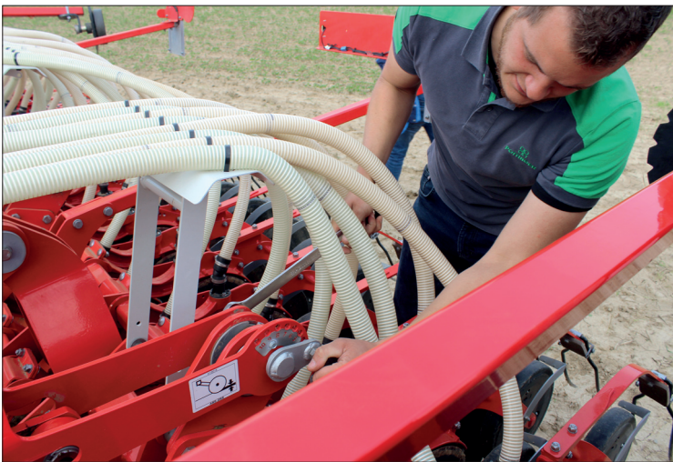
K nastavení hloubky setí slouží děrná lišta s deseti otvory. Přítlak lze zvolit až do 60 kilogramů na secí botku
