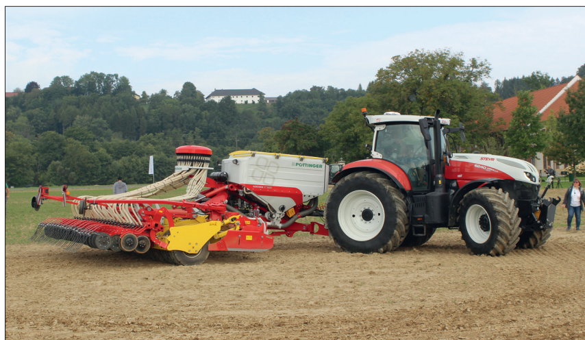
Traktor se na souvratích může k secí kombinaci natočit v úhlu až devadesáti stupňů. Bod otáčení secí kombinace je posunutý dozadu
