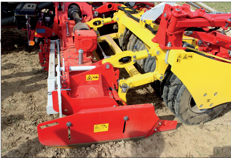
K válci jsou rotační brány připojeny prostřednictvím paralelogramu. Do závěsu je integrováno hydraulické odpružení, absorbující vibrace, takže secí kombinace se chová na poli klidně
