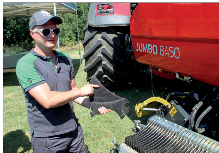
Nože pro vozy Jumbo řady 8000 mají nový tvar a jednostranný výbrus
