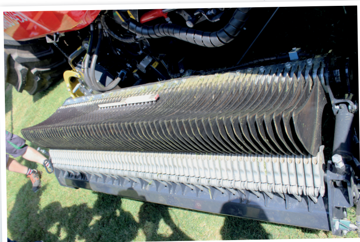
Nadupaná „Banka nožů“, schovaná pod podlahou nových návěsů Pöttinger Jumbo 8000 – jeden vedle druhého si ve výklopném nosníku Easy Move pěkně sedí celkem 65 nožů, samozřejmě s osvědčeným dvojím jištěním pata-špička
