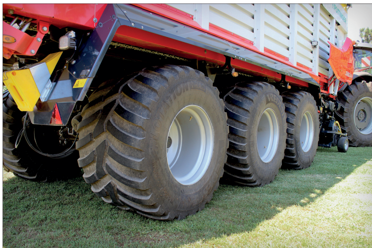
Pöttinger tradičně myslí i na šetrné působení na půdu či na travní drn. Pro největší ráfky o průměru 30,5 palce připadají v úvahu rozměry 710/50-R30,5 a 800/45-R30,5 Flotation Trac výrobce Apollo Vredestein
