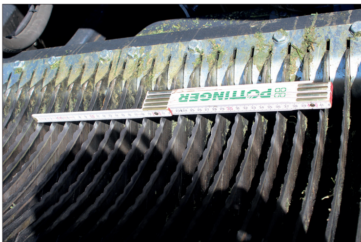
Detail s přiloženým skládacím dřevěným metrem potvrzuje informace výrobce: teoretická délka řezanky činí pouhých 25 milimetrů!
