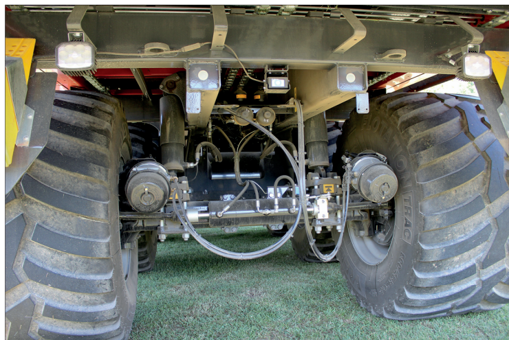
Nová generace návěsů Jumbo 8000 může být vybavena novinkou, elektronicky ovládaným bezkontaktním systémem nuceného řízení. A to s podvozkem tridem i s tandemovou nápravou
