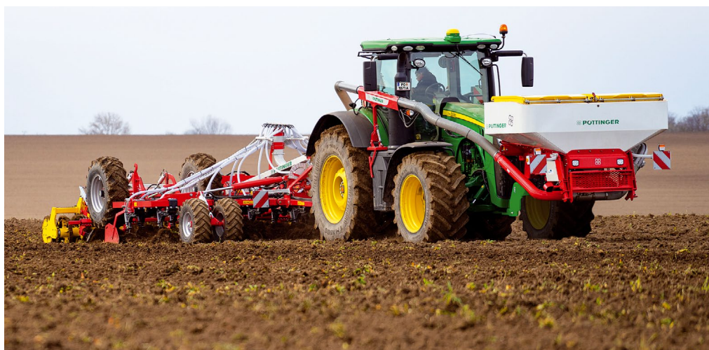
Ve spojení s radličkovými kypřiči TERRIA nabízí čelní zásobník AMICO možnost aplikace hnojiva nebo krycích plodin. Volitelně je zásobník k dispozici s objemem 1 700 nebo 2 400 litrů a s jednou nebo dvěma dávkovacími jednotkami.
