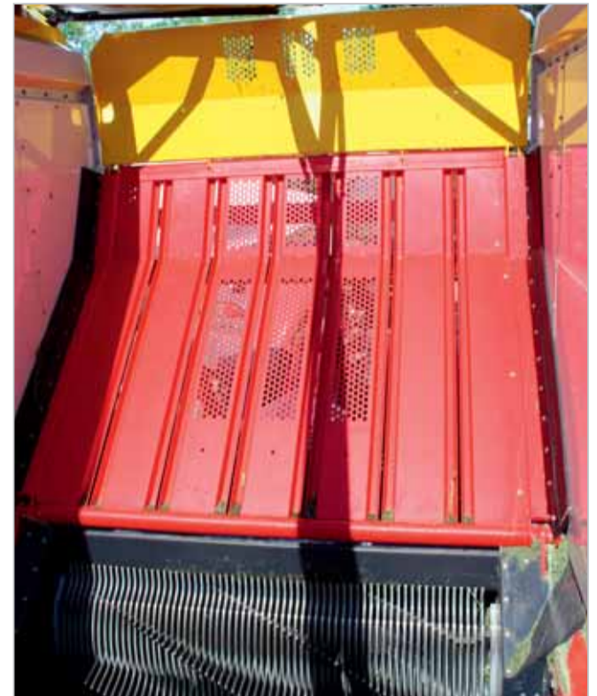
Automatika plnění má nyní nově k dispozici ještě informace od přídavného senzoru. Ten měří úroveň předběžného stlačení hmoty v prostoru přímo nad plnicím rotorem. Je-li dosaženo mezních hodnot, pak dojde automaticky k aktivaci podlahového dopravníku Foto Petr Beneš
