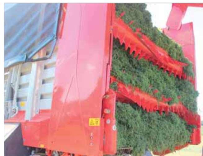
Dva nebo na přání tři rozdrůzovací válce jsou osazeny agresivními frézovacími zuby, uspořádanými do písmene V. Zuby plynule odebírají stlačený materiál z ložné plochy. Jednotlivé zuby jsou spojené lištami, které urychlují proudění rozdrůzené hmoty ven z návěsu Foto Petr Beneš
