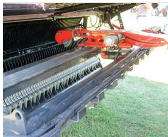
Na návěsích Pöttinger Jumbo 8000 je instalován Autocut druhé generace Foto Petr Beneš
