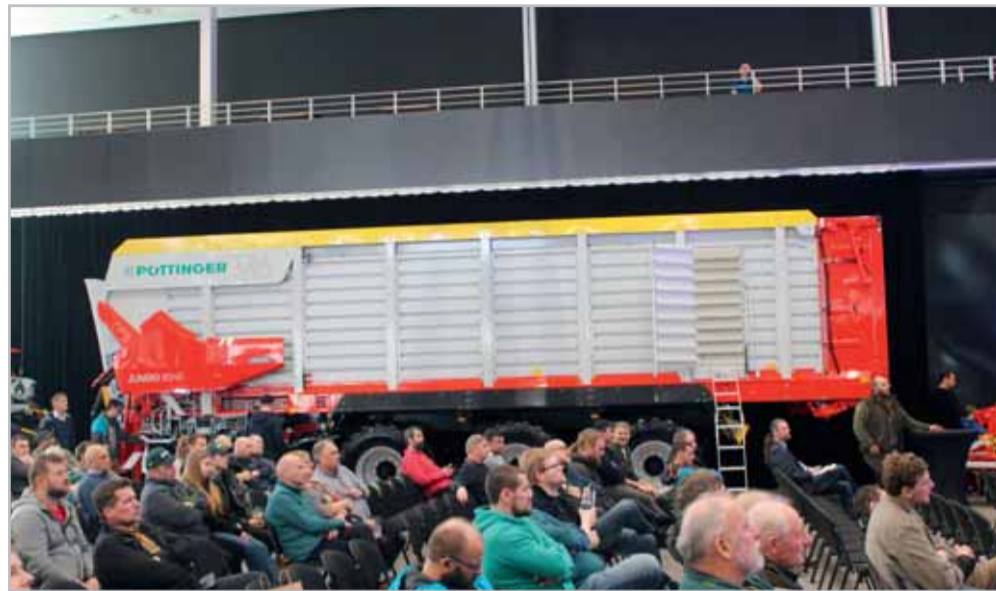
Víceúčelový návěs Pöttinger Jumbo 8540 měl premiéru v ČR. Ve svém stranově výklopném nosníku Easy Move měl usazeno celkem 65 nožů, které dokáže po celý den udržovat dokonale nabroušené automatické broušící zařízení Autocut nové generace Foto Petr Beneš
