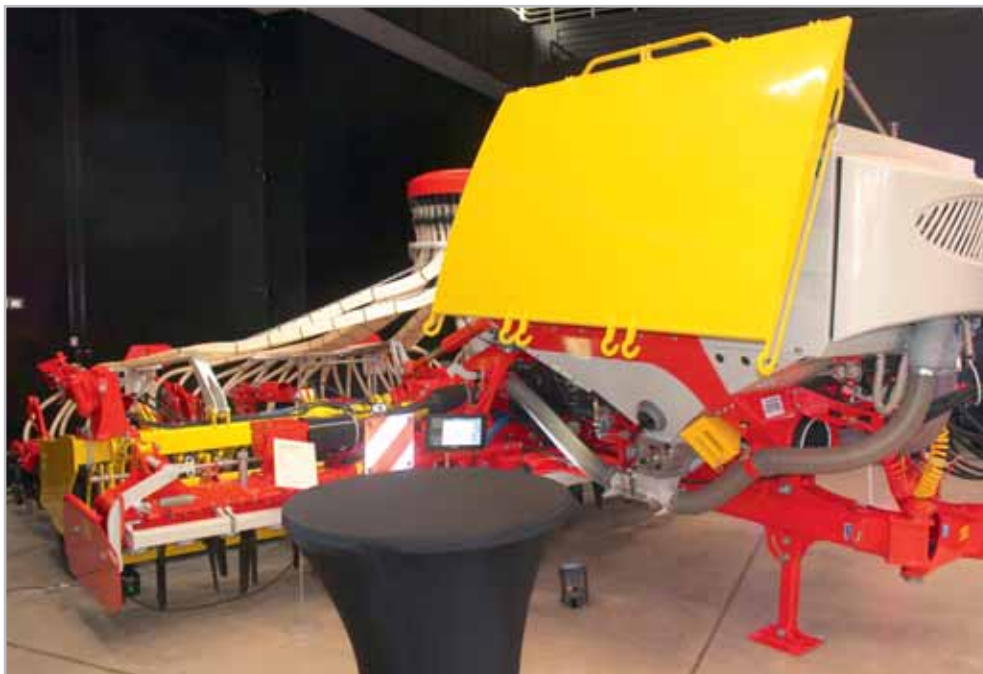
Nová secí kombinace Pöttinger Aerosem VT 5000 DD skrývá velké množství inovací, jako je například podélně dělený zásobník s dvojicí výsevních ústrojí
