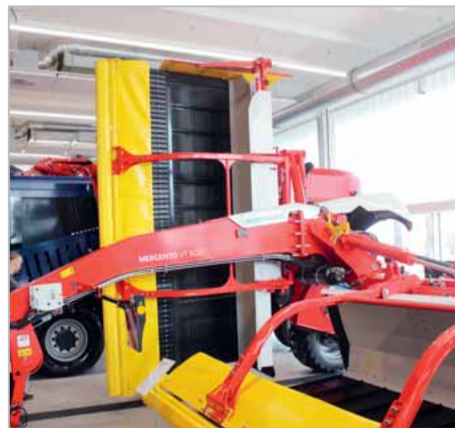
Pásový řádkovač Pöttinger Mergento VT 9220 se vyznačuje nízkou energetickou náročností a šetrností ke sklizené píci Foto Petr Beneš
