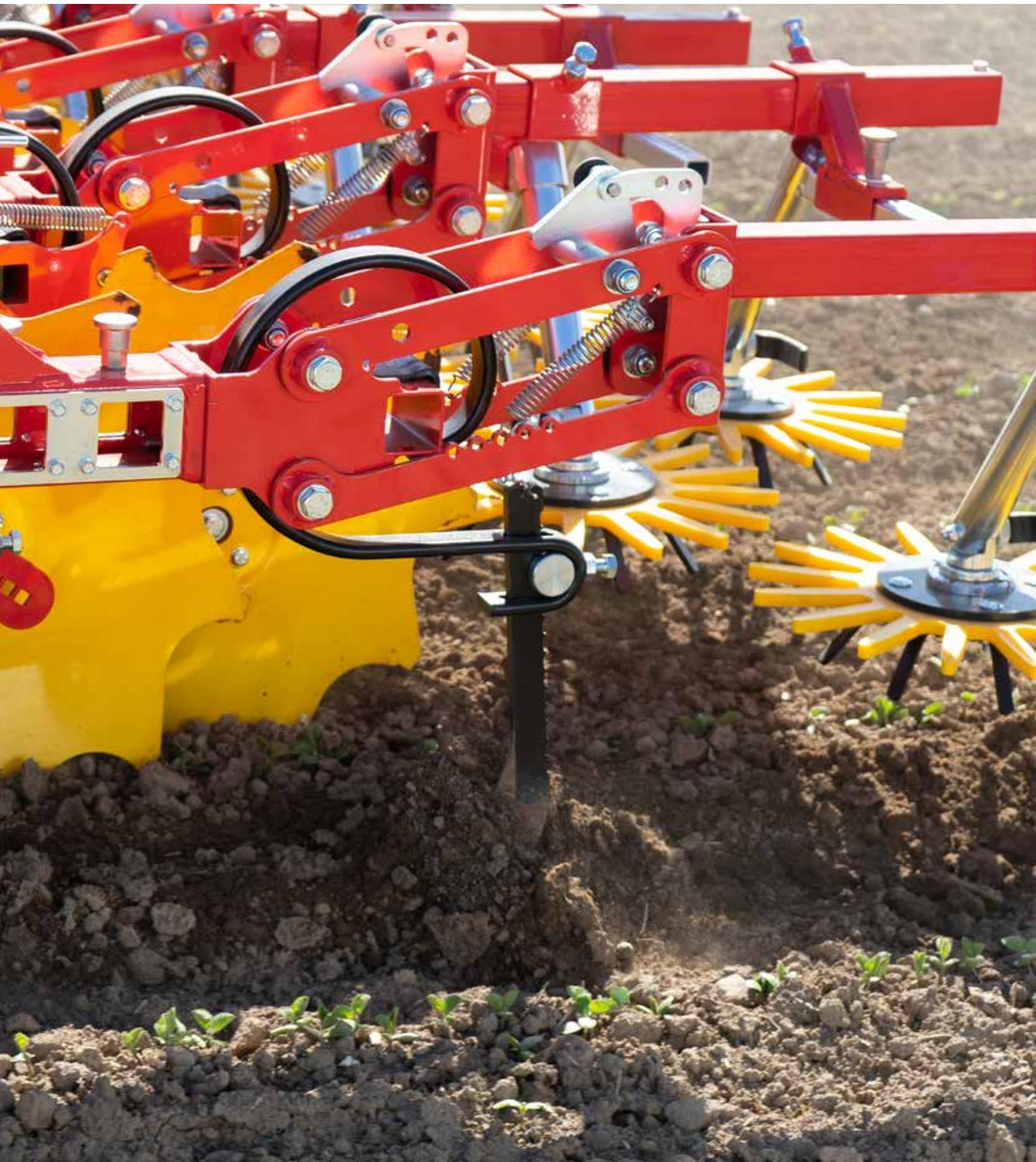
Díky svému jedinečnému konceptu nabízí radličkové plečky FLEXCARE od firmy PÖTTINGER plnou flexibilitu při použití v různých kulturách. Rozteč řádků, pracovní záběr radliček a jemné nastavení plečky lze zcela upravit bez nutnosti použítí náradí. Stroj se vyznačuje přesným hloubkovým vedením a šetrnou kultivační metodou.
