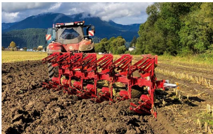
Pluh Pöttinger SERVO T 6000 PLUS s páskovými odhrňovačkami v ich ťažších, ílovitých pôdach robí dobrú robotu.
