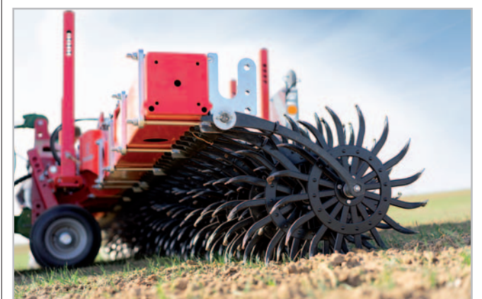
Mechanická rotační plečka Pöttinger Rotocare účinně narušuje škraloup a provzdušňuje ornici. Tím přispívá i ke správné tvorbě půdní struktury
