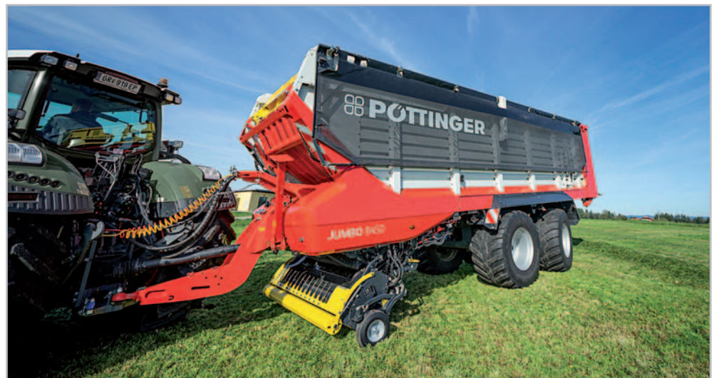
Sběrací vůz Jumbo 8450 vytváří krátkou řezanku, což má výrazný vliv na vysokou kvalitu píce i užitkovost a zdraví skotu
