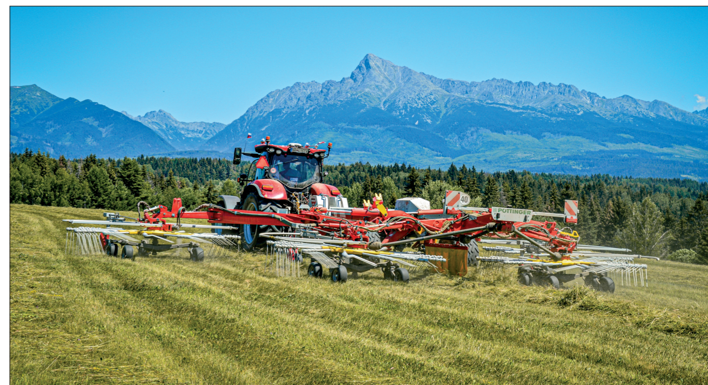
Zhrabovač Pöttinger TOP 1403 C výborne kopíruje terén, pričom pracovný záber dosahuje až 14 metrov.
