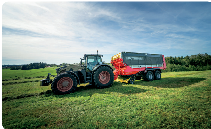
Nové návěsy Pöttinger Jumbo série 8000 zahrnují šest typů s objemem ložné plochy od 38 do 54 krychlových metrů podle DIN, na tandemovém podvozku či s nápravou tridem
