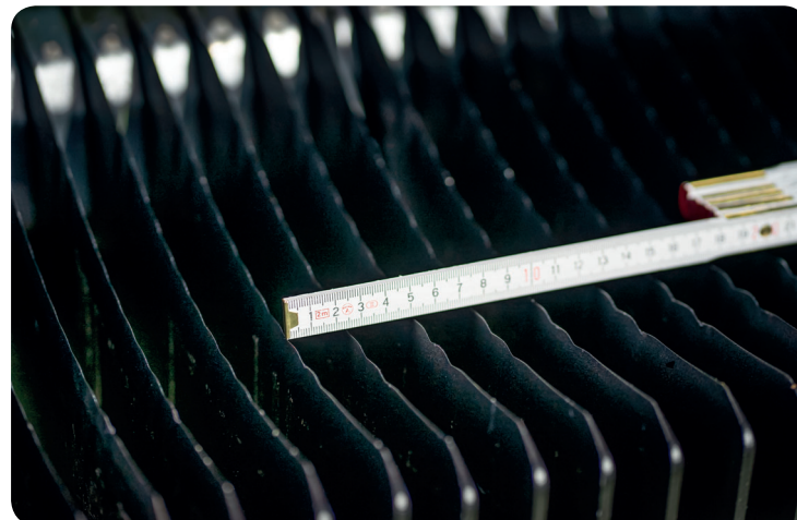
Detail s přiloženým skládacím dřevěným metrem potvrzuje informace výrobce: teoretická délka řezanky činí pouhých 25 milimetrů
