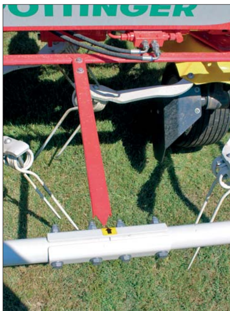
Je-li nesený obraceč HIT V 11100 vybaven možností krajového obracení, pak tento ukazatel informuje obsluhu traktoru o aktuálně nastavené poloze stroje
