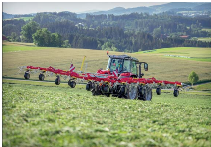
Při zvedání obraceče na souvratí jsou rotory nejprve přestaveny do vodorovné polohy a následně zvednuty. Tím nedochází k zapichování prstů obraceče do půdy a předchází se znečišťování píce
