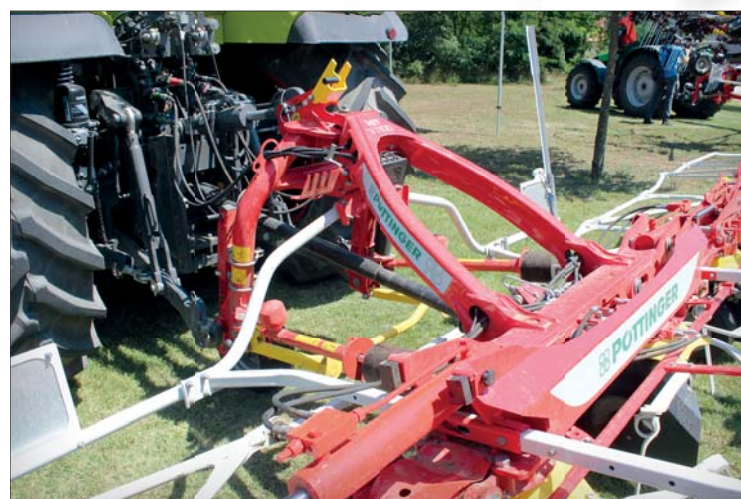
Základem kompaktní jednotky obrabeče s traktorem je krátký tříbodový závěs, který posouvá těžiště stroje do větší blízkosti k traktoru. Nechybí ani osvědčená srdcovitá vodicí dráha
