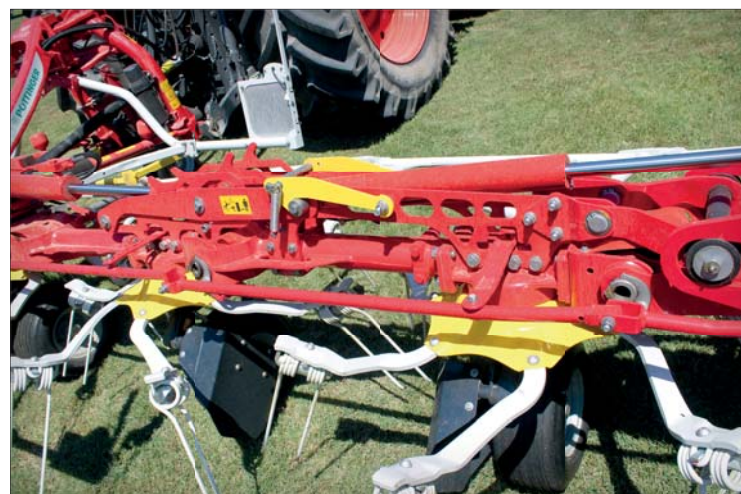
Přhradová konstrukce vyztužuje šroubované tvarové trubky hlavního rámu. Tím se zvyšuje odolnost a životnost celého obraceče
