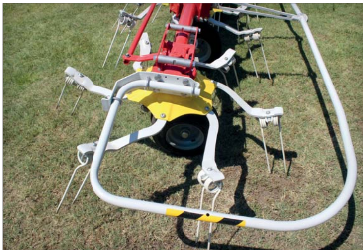
Rotory Dynatech o průměru 1,42 m se pyšní unikátním zakřivením ramen. Díky tomu provádí precizní zachytávání hmoty a její rovnoměrný a vzdušný rozhoz po celém záběru
