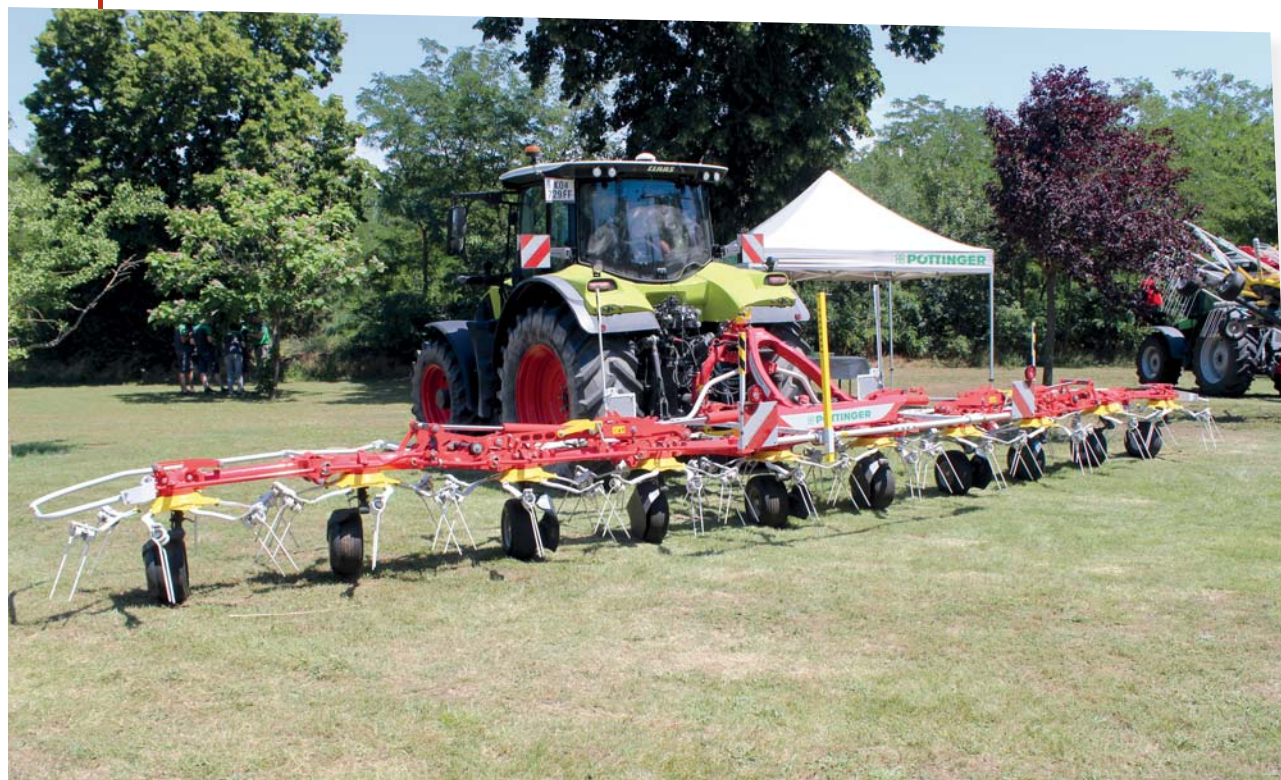
Firma Pöttinger si svůj sortiment rotorových obrabečů píce rozšiřuje o novinku – obrabeč HIT V 11100. S deseti rotory disponuje pracovním záběrem 10,70 m a agreguje se jako nesený
