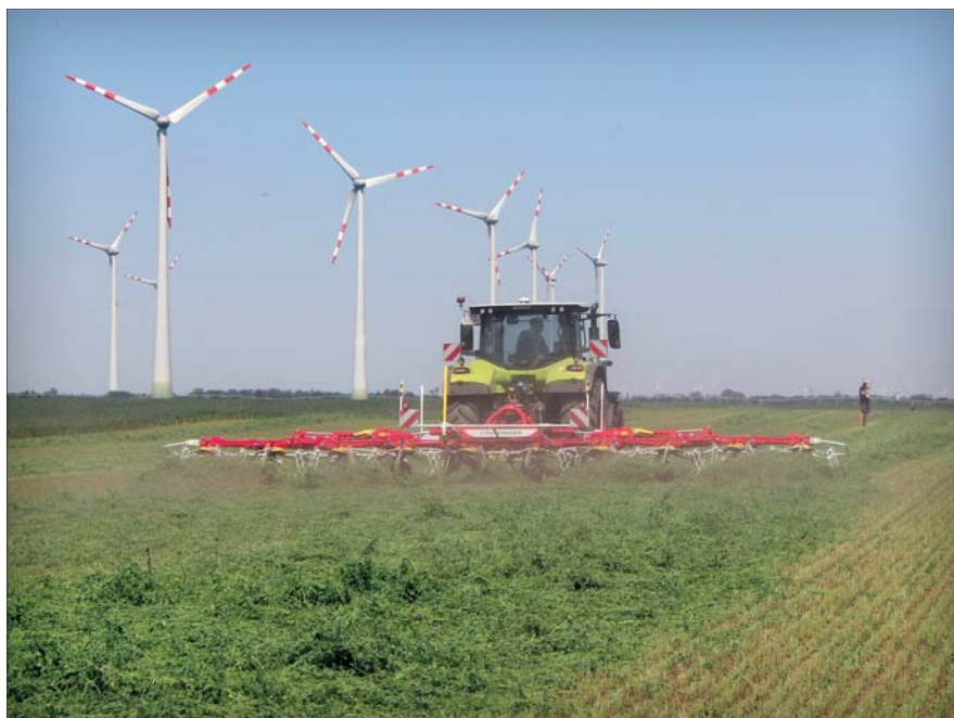
Při praktické ukázce předvedl desetitorový nesený obraceč HIT V 11100 rovnoměrný rozhoz posečené vjštěsky
