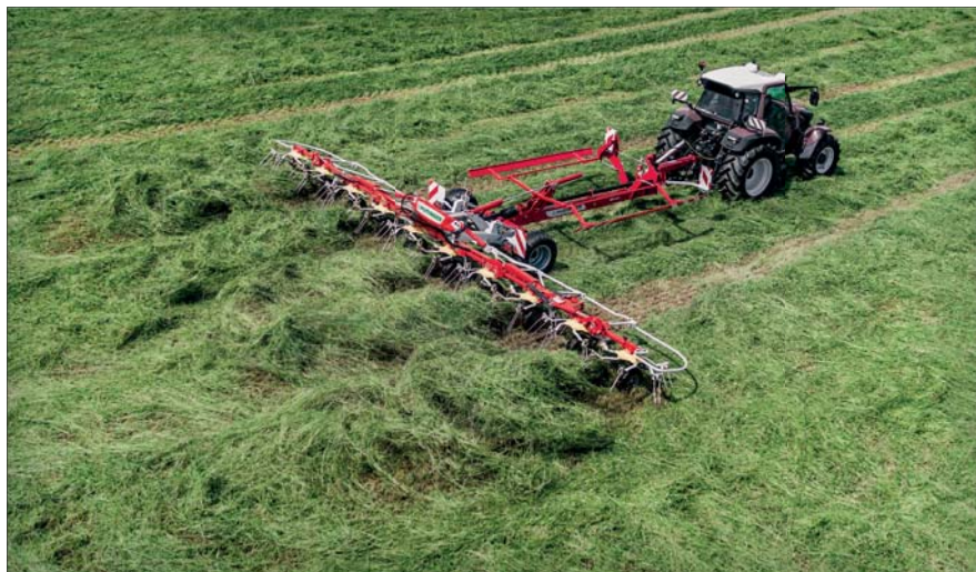
Polonesený obraceč HIT HT 11100 je osazen deseti rotory a má téměř shodnou šířku záběru jako nesený typ HIT V 11100. Díky své nápravě může být agregován s lehčími traktory. A připojení k traktoru je výrazně jednodušší a rychlejší než u obraceče neseného
