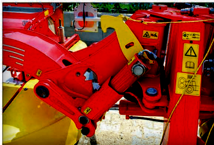
Vysouváním této pístnice se žací stroj sklápí do transportní polohy a zpět. V šikovně vyřešené transportní poloze se žací stroj překlápí přes mrtvý úhel. Díky tomu není traktor v průběhu přepravy tolik zatěžovaný
