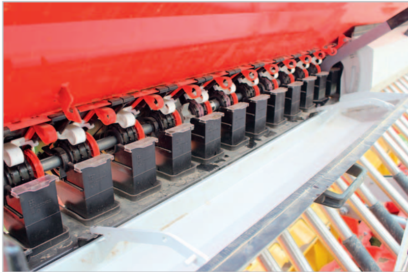
Multisystém 3 v 1 firmy Pöttinger spočívá v tom, že přechod mezi jemným a běžným setím se provádí jednoduše zasunutím, resp. vytažením jednotlivých dávkovacích hradítek. Změna dávkování je jednoduchá a rychlá
