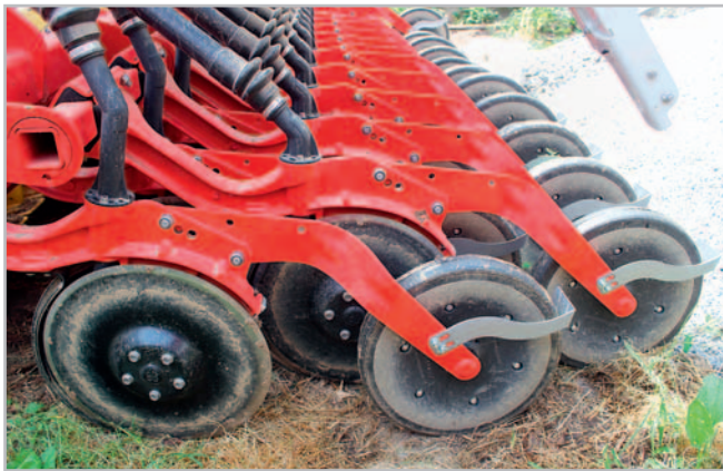
Dvoukotoučové secí botky zvládají výsev v prostředí s posklizňovými zbytky na povrchu půdy hladce
