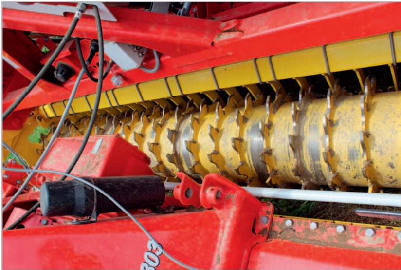
Zubový opěrný válec zanechává optimálně zpevněné osivové lože s jemnou zeminou v úrovni setí. Proti zalepování je vybaven zušlechtěnými škrabkami (volitelná výbava)
