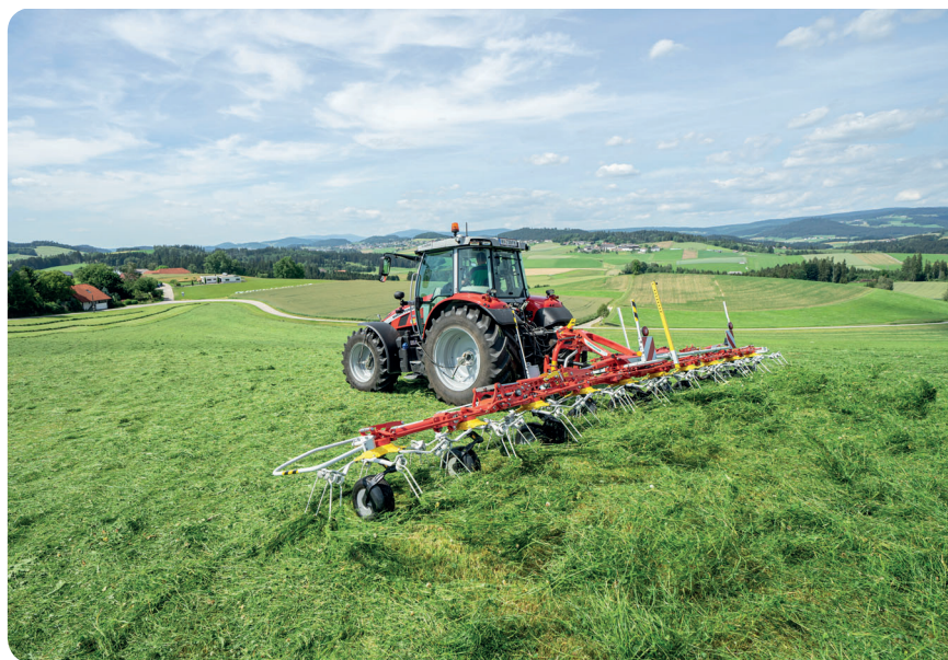
Novinka firmy Pöttinger, obraceč HIT V 11100, nabízí v neseném provedení a s deseti rotory pracovním záběr 10,70 m (podle normy DIN). S traktory o výkonu 100 až 130 k lze dosahovat velké plošné výkonnosti
