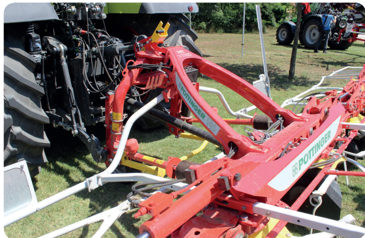
Základem kompaktní jednotky obrabeče s traktorem je krátký tříbodový závěs, který posouvá těžiště stroje do větší blízkosti k traktoru
