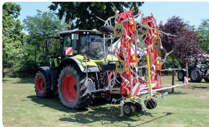
Složený do transportní polohy je velký obrabeč pěkně kompaktní. V přepravní poloze jsou dva vnější rotory na každé straně otočeny o 180° a obrabeč má výšku 3,45 m
