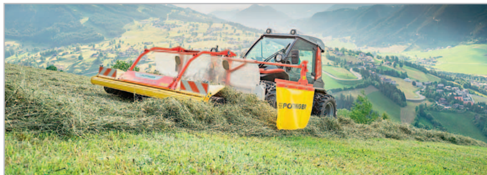
Pásový shrnovač se připojuje do předního závěsu traktoru nebo speciálního horského nosiče nářadí Foto archiv
