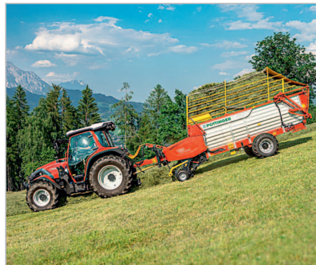
Sběrací vozy Pöttinger Boss 2000 Alpin mají nízké těžiště. Maximální stabilitu zajišťuje i rozchod kol 2,09 m a kola vedle karoserie Foto archiv
