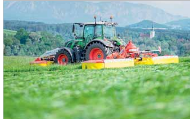
Centrální zavěšení žacích jednotek umožňuje příčný výkiv lišty až +20°/-16°, který je výhodný především na nerovných a příkrých plochách
