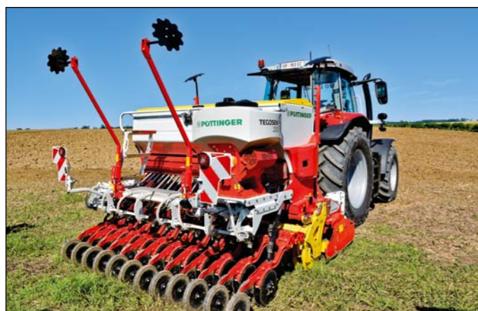
Oproti predchádzajúcej generácii sa objem zásobníkov jednotlivých modelov VITASEM zvýšil až o 25 percent. Stroj je možné vybaviť aj sejačkou TEGO-SEM 200 na medzplodiny alebo podsev.
