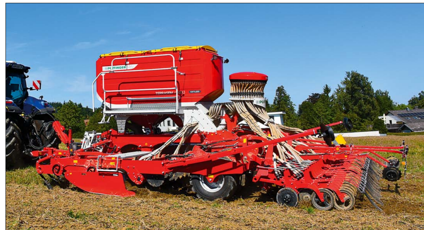
Sejací stroj TERRASEM Profiline je zásobovaný olejom iba systémom Load Sensing traktora a všetko náradie sa ovláda elektro-hydraulicky cez hydraulický blok.
