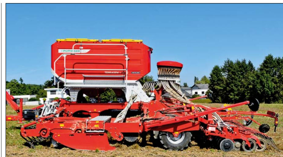
Všetky pracovné nástroje TERRASEM môžu byť automaticky presne polohované pomocou Task Control. Rovnako ventilátor a prítlak výsevných pätičiek.
