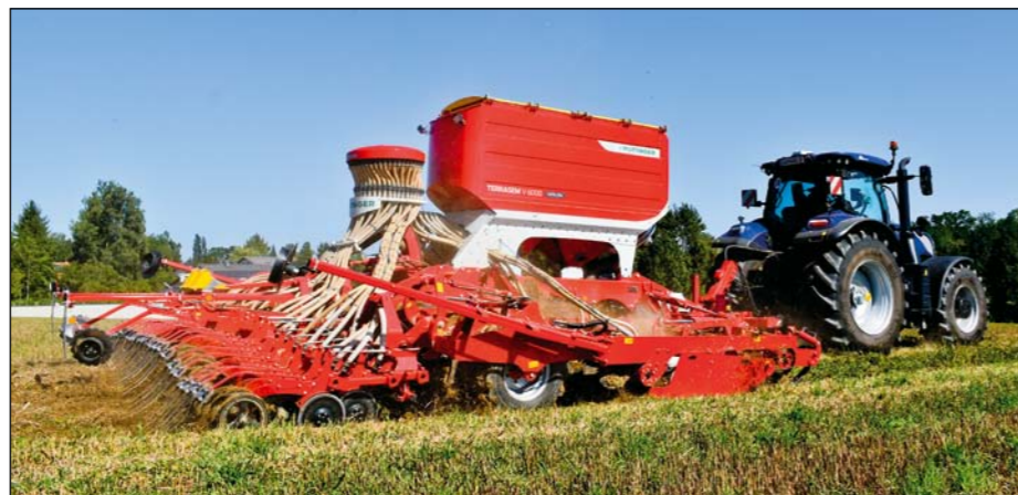
Aktiváciou Task Controller Geo a Section Control je možná prevádzka sejacieho stroja TERRASEM cez aplikačné mapy.
