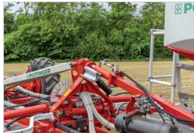
Radličkové kypřiče modelové řady Terria mohou být vybaveny systémem trakčního posilovače Traction Control
