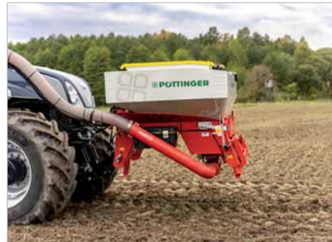
Čelně nesený zásobník Pöttinger Amico F může být vyroben s objemem 1700 nebo 2400 litrů, s rozdělením na dvě komory v poměru 60 : 40. Standardně je ovládán pomocí ISOBUS
