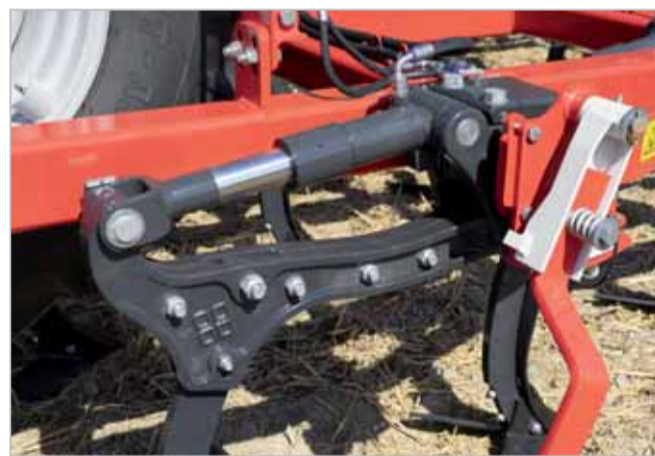
Terria může být vybavena novým systémem hydraulického non-stop jištění s vypínací silou 6,5 kN (odpovídá 650 kg). Výhoda spočívá v tom, že vypínací tlak je možné centrálně nastavit a upravit z kabiny traktoru podle potřeby
