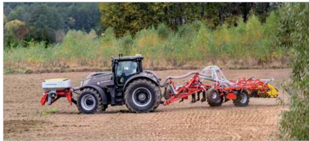
Kombinace radličkového kypřiče Terria firmy Pöttinger s čelně neseným zásobníkem Amico F umí provést nakypření půdy a současnou aplikaci hnojiva do půdního profilu, kde mohou být živiny vegetujícími rostlinami kulturní plodiny využity přímo a beze ztrát
