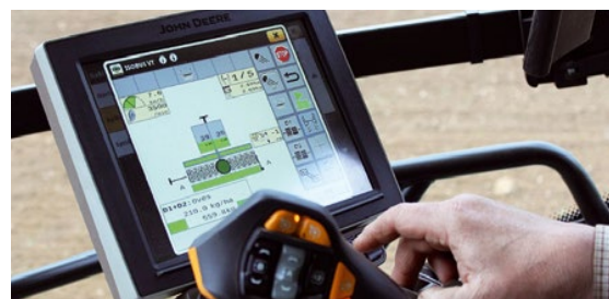
Nastavování a ovládání secí kombinace AEROSEM VT 5000 DD obsluha provádí prostřednictvím monitoru v kabině traktoru.
