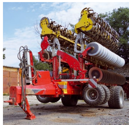
Polonesený diskový podmítač TERRADISC 8001 T s pracovním záběrem 8 metrů zaručuje vysokou výkonnost. Při dopravě je sklopný na šířku 3 metry.
