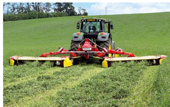
Žací kombinace NOVACAT V 9200 RC se středovým uchycením žací lišty má pracovní záběr 9,2 metru.
