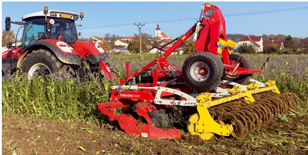
Diskový podmiťáč TERRADISC 6001 T při zapravování meziplodiny – směsky čiroku a svazanky vrtičolisté.
