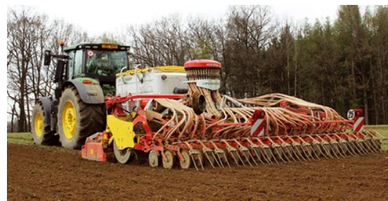
Nastavování a ovládání secí kombinace AEROSEM VT 5000 DD obsluha provádí prostřednictvím monitoru v kabině traktoru.
