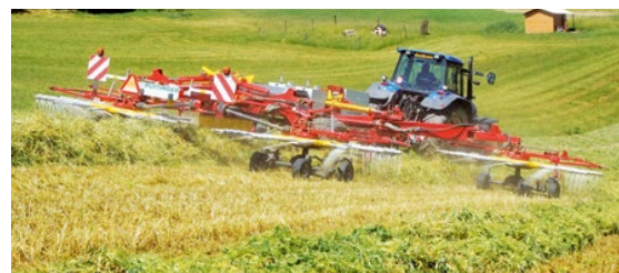
V případě překážek nebo klínů využívají samostatné ovládání jednotlivých rotorů shrnovače TOP 1252 C.
