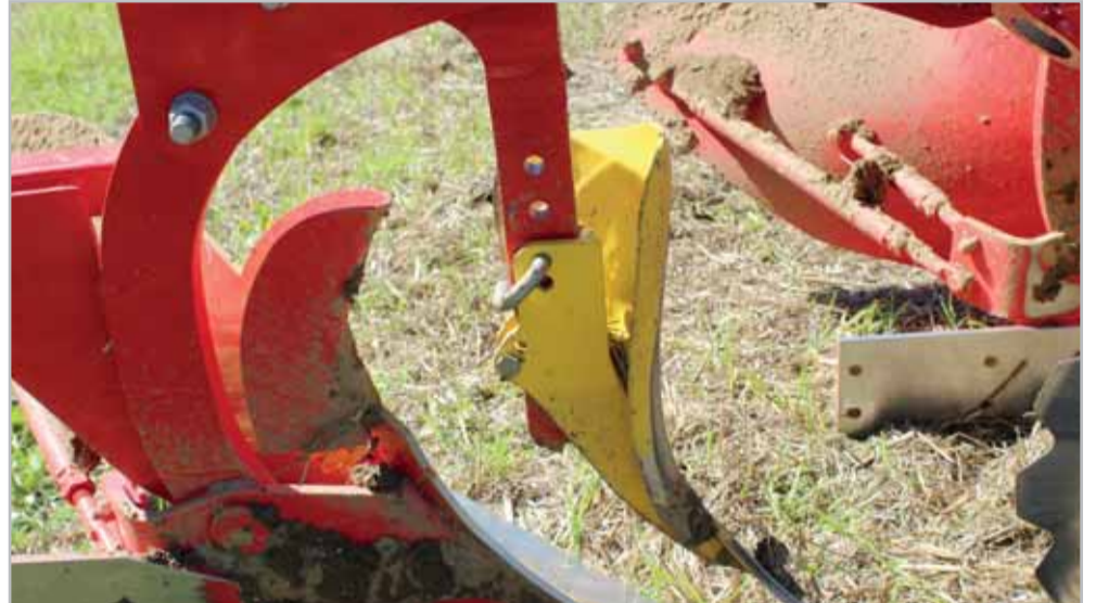
Předradličky nabízí firma Pöttinger v nejrůznějším provedení. Výška předradliček je nastavitelná bez použití nářadí v několika polohách
