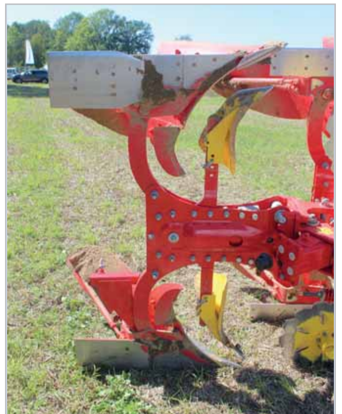
Pluhy Servo 3000 mají nově vyvinutý systém non-stop jistění orebních těles proti přetížení Nova. Hydraulický válec je uložený uvnitř, kde je spolehlivě chráněn před poškozením a vnikáním nečistot
