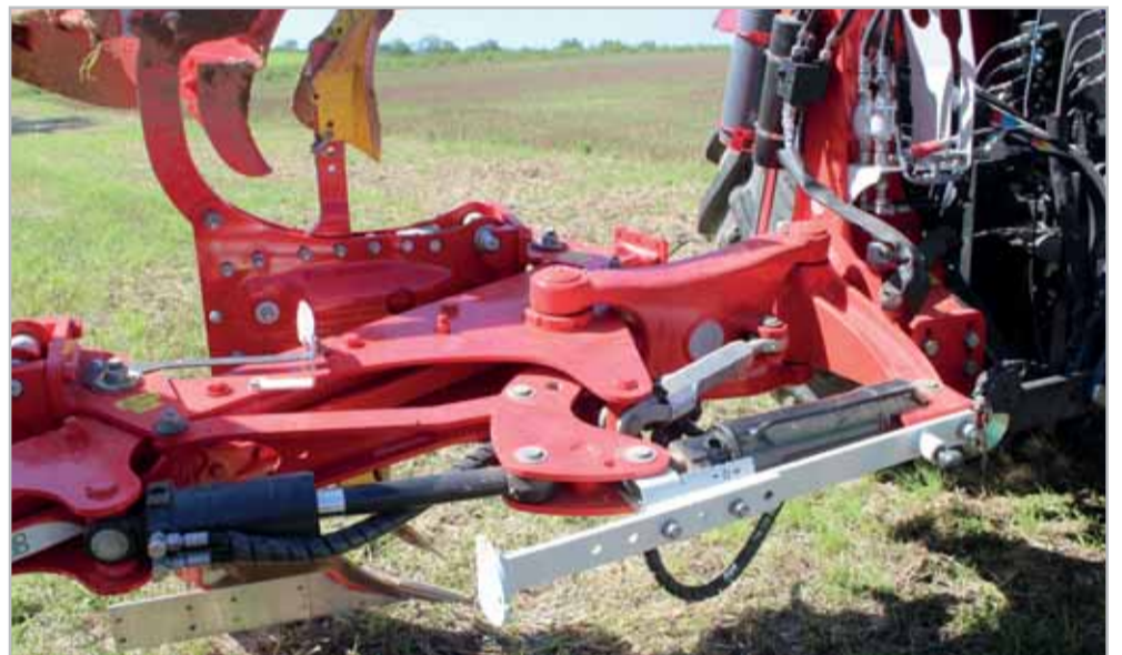
Systém se čtyřkloubovou kinematikou nově vyvinutého nastavovacího centra Servomatic umožňuje snadné nastavení pluhu podle parametrů použitého traktoru
