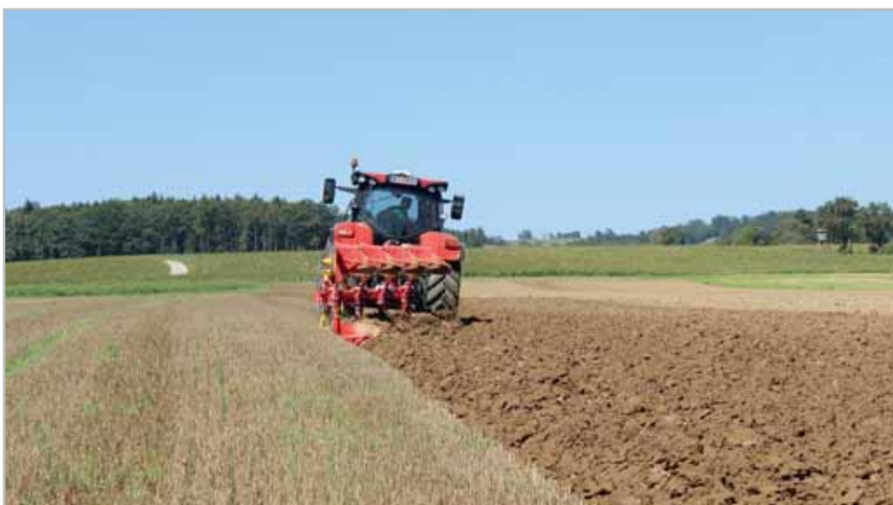
Prezentovaný pluh byl osazen orebními tělesy 46 WC, která ve vlhké, kamenité půdě předvedla dokonalé zaklopení posklizňových zbytků a velmi dobré drobení ornice. 46 WC jsou jedny z nejprodávanějších orebních těles firmy Pöttinger
