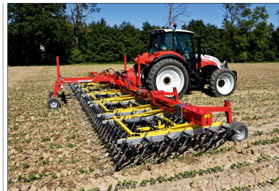
Rozstup na bránach TINECARE medzi skupinami hrotov je 330 mm a vzdialenosť medzi samotnými hrotmi 30 mm.
