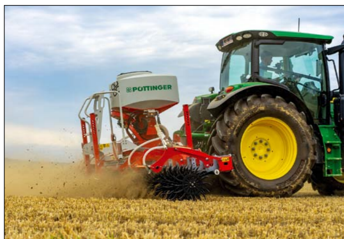
Rotačná plečka ROTOCARE ponúka aj možnosť na plytké spracovanie strniska, so sejbou medziplodín v jednom prejazde pomocou zásobníka TEGOSEM.
