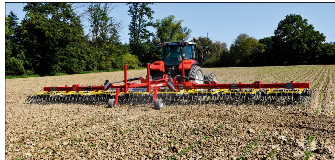
Pracovná šírka môže byť tiež znížená z 12,20 na 9,00 metrov pomocou viacdielneho skladacieho rámu.
