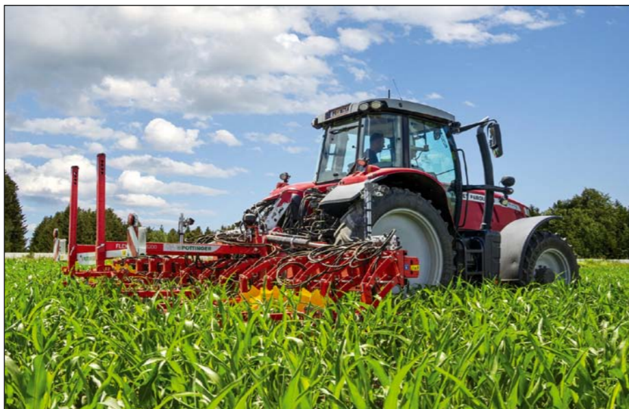
Súčasťou výbavy kultivačnej plečky FLEXCARE je aj presné automatické navádzanie pomocou kamery.
