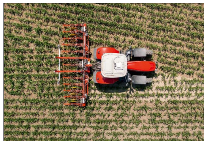
Voliteľný systém Section Control zdvíha a spúšťa pracovné sekcie plečky FLEXCARE s dokonalou presnosťou pomocou GPS.
